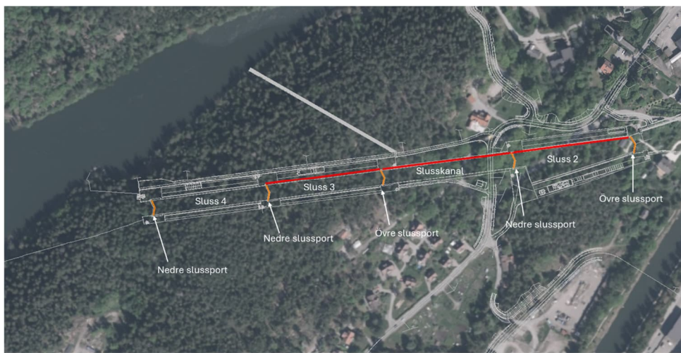
Figur 2. Översiktlig plan på slussanläggning och slussportar.
