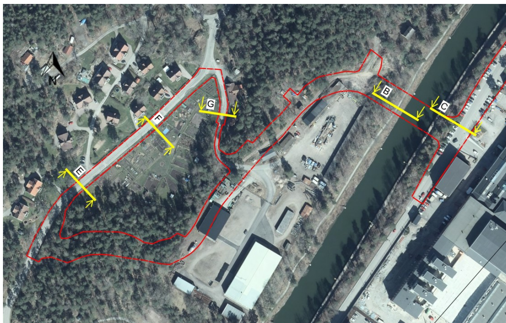
Figur 16. Sektioner där stabiliteten har kontrollerats.
