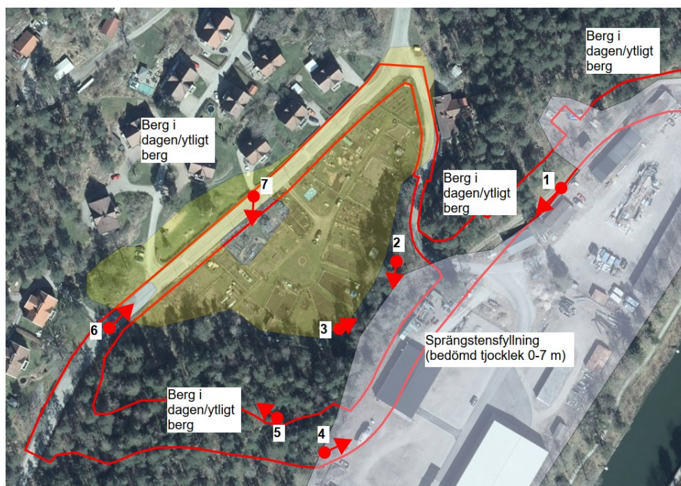
Figur 5. Översikt över bedömda jordlagerförhållanden i planområdets sydvästra del samt fotonummer och fotoriktning för nedanstående foton. Blå markering visar bedömd utbredning av sprängstensfyllning. Gul markering visar bedömt område med lera. Röd linje markerar planområdesgränsen.
