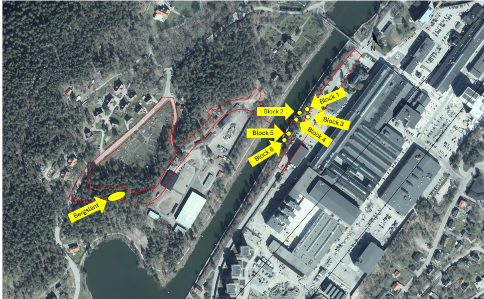
Figur 17. Block 1–6 markerade på östra stranden av kanalen. Område för bergslänt med potentiellt instabila block ses även i figur. Röd linje visar var planområdets gräns går.
