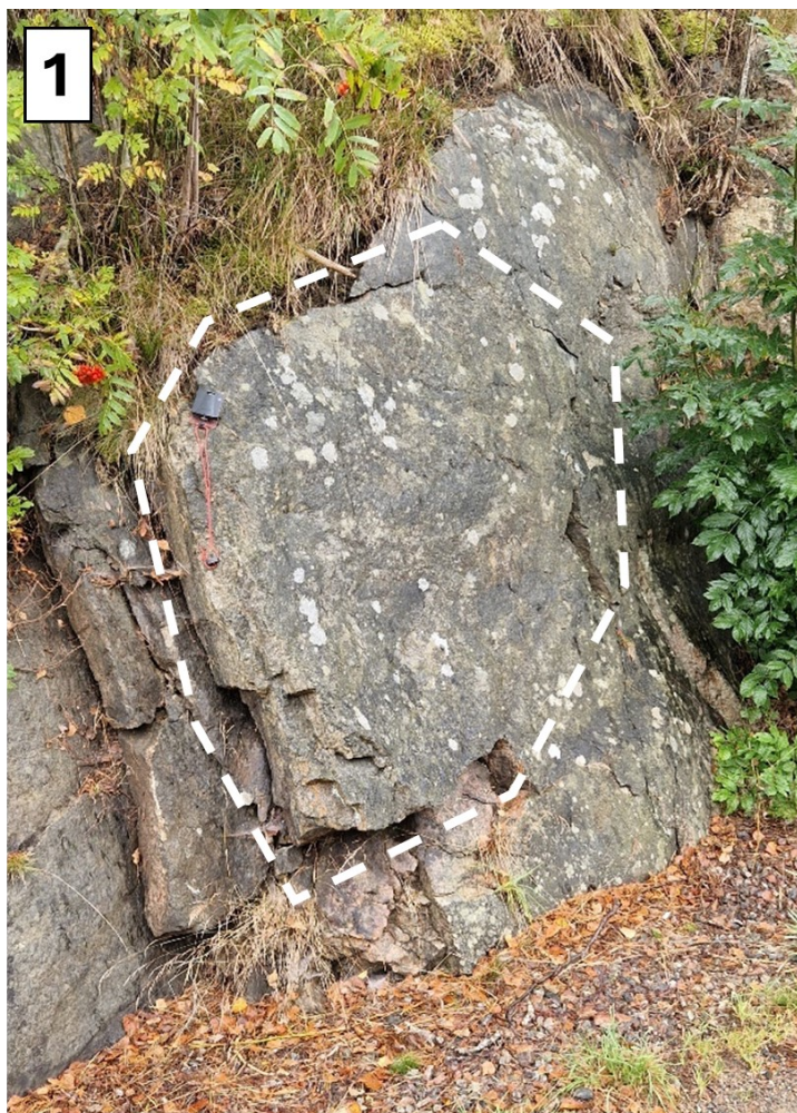
Figur 9. Instabilt block (1) i anslutning till gångväg.
