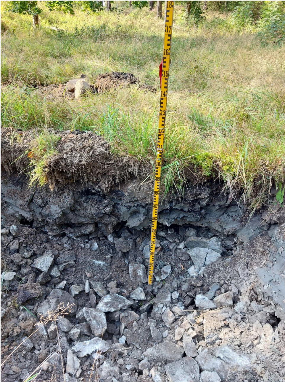
Foto 8. PG4 (NY) Sandigt grus med lera och mulljord på toppen. Här luktade det mycket starkt av en petroleumförorening mellan 0,0-0,5 m under markytan.
