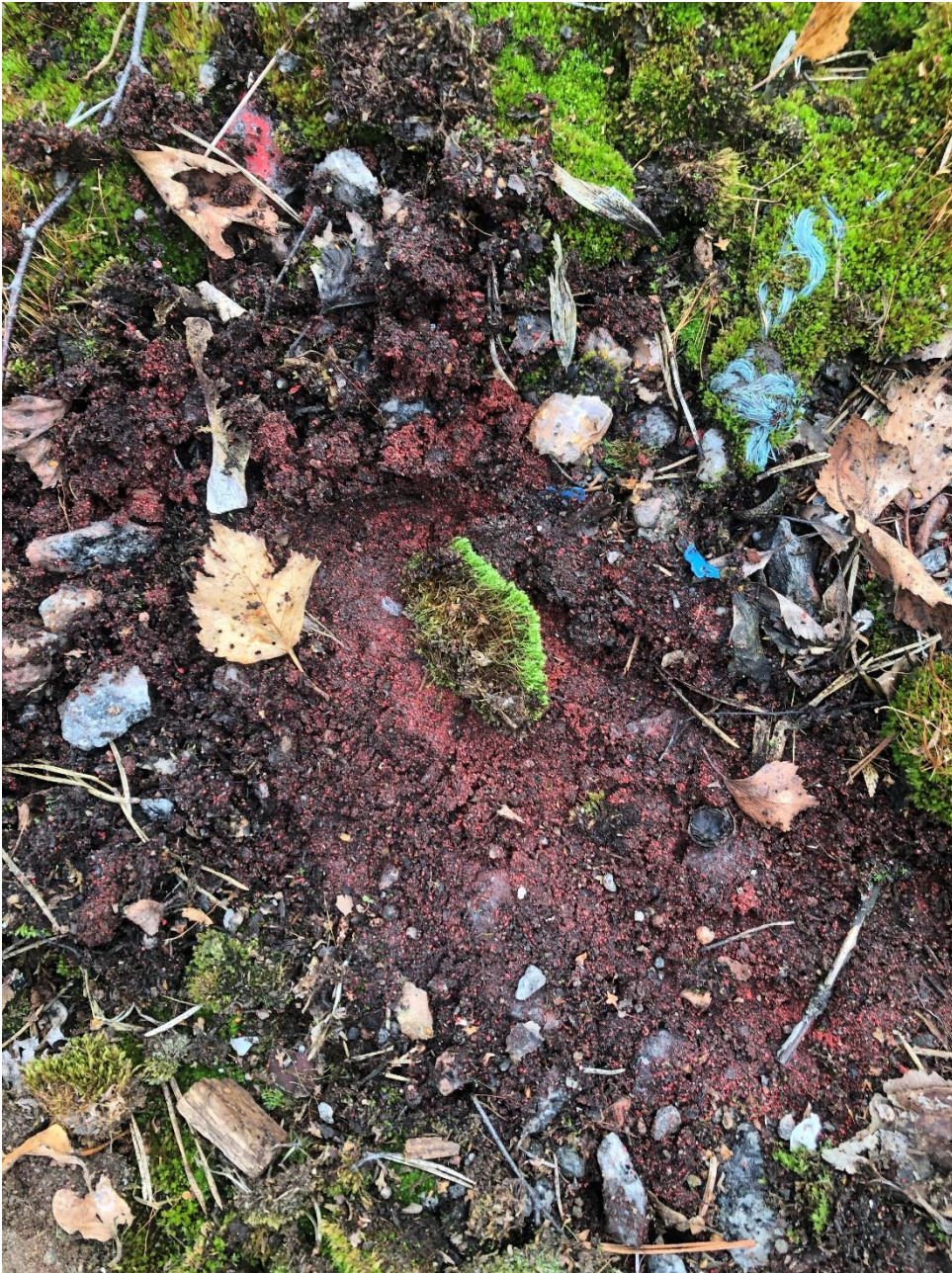
Foto 12. PG4B: Under mossan var det sandiga gruset rödfärgat (misstänkt båtbottnfärg?).
