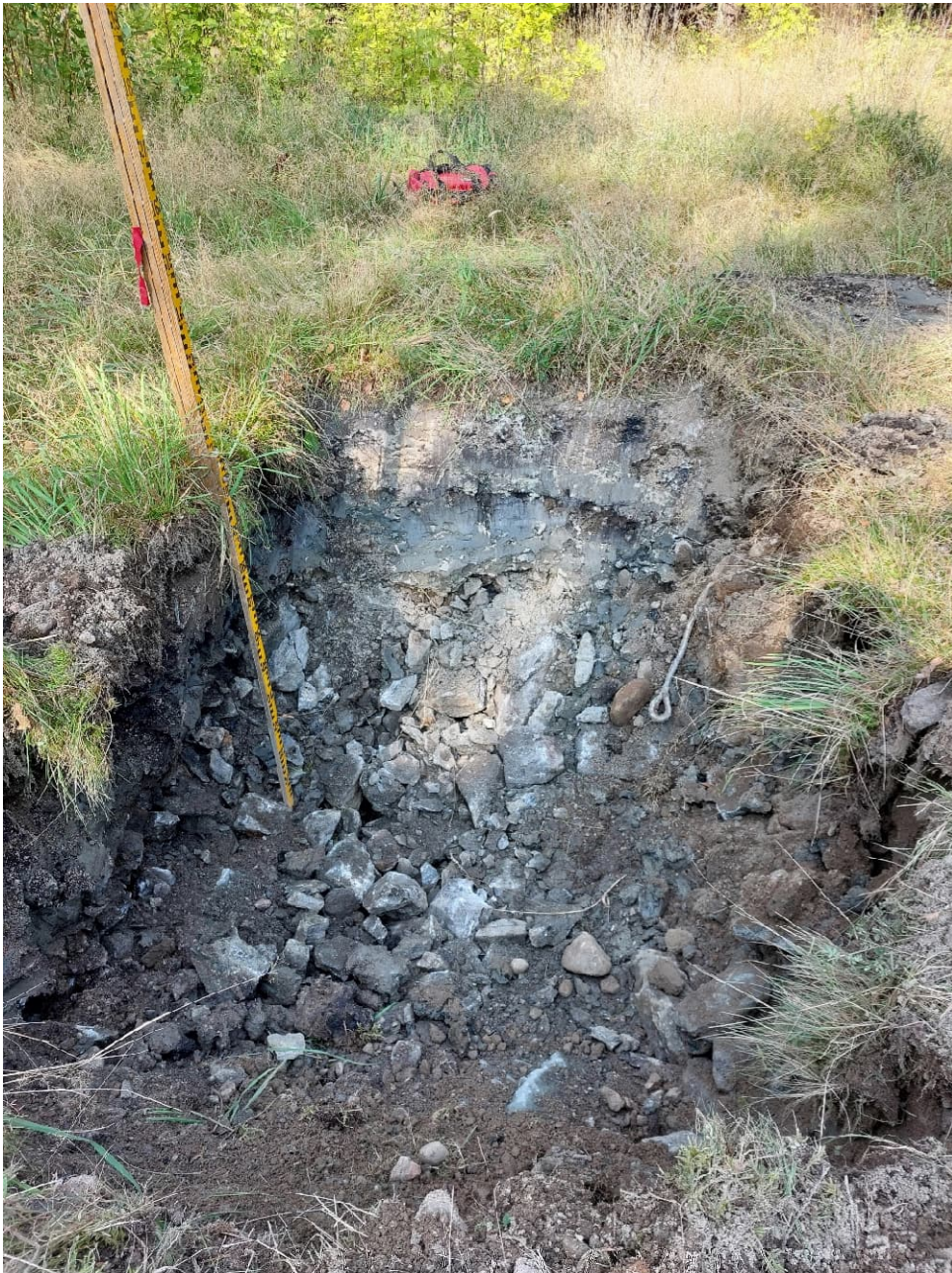
Foto 9. PG 4 (NY) Sandigt grus med mindre sprängsten. Petroleum föroreningen luktade svagare mot djupet.
