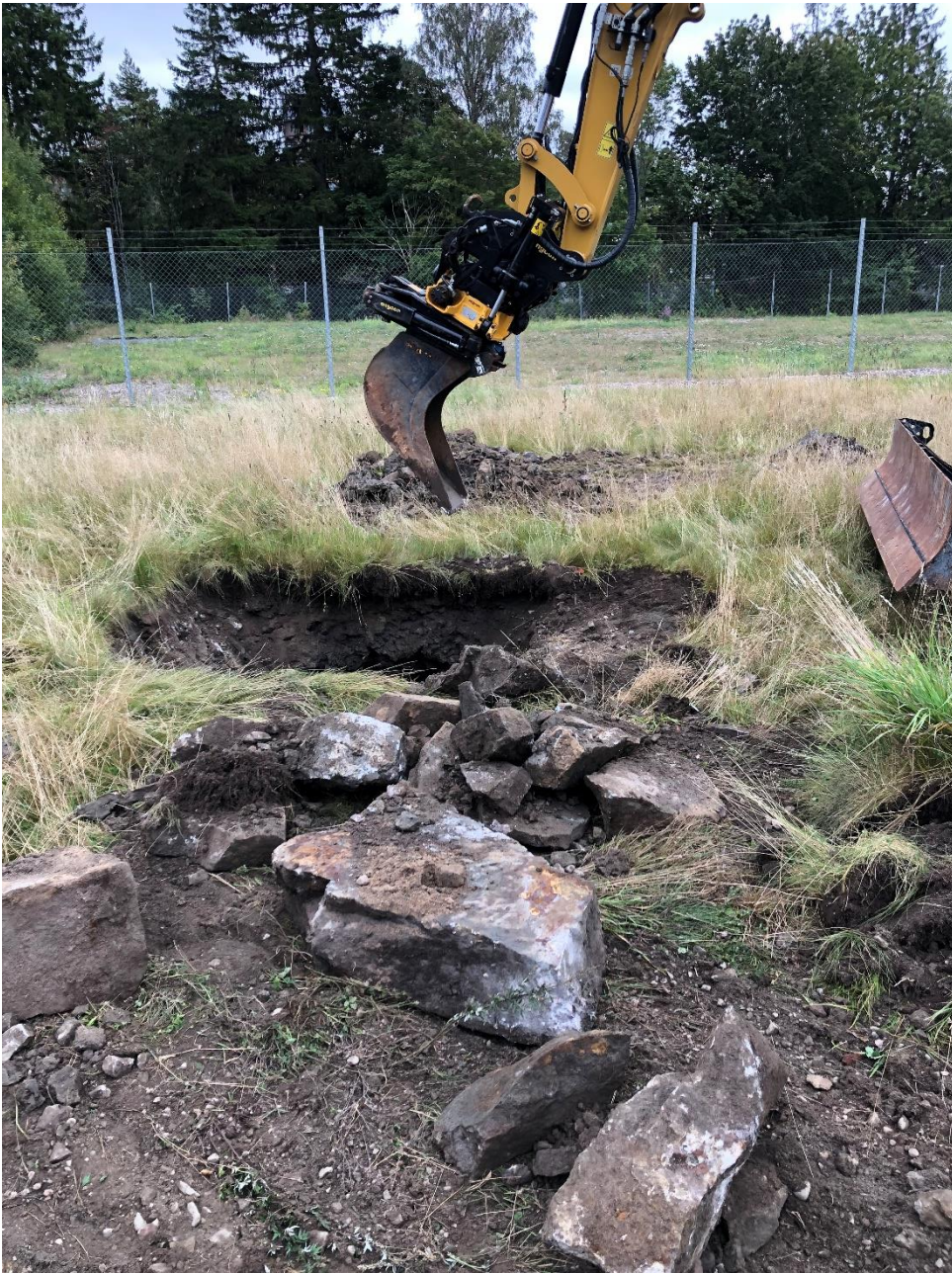
Foto 4. PG2: Sandigt grusigt fyller med lite mulljord på toppen, mellan 0,5-1,0 m inslag av lera.
