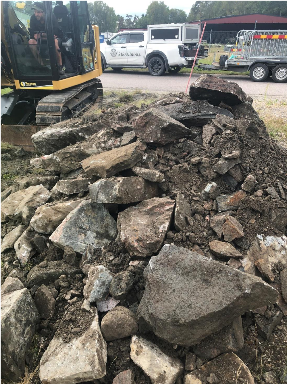
Foto 5. PG2: Från 1 m under markytan sprängsten och block.
