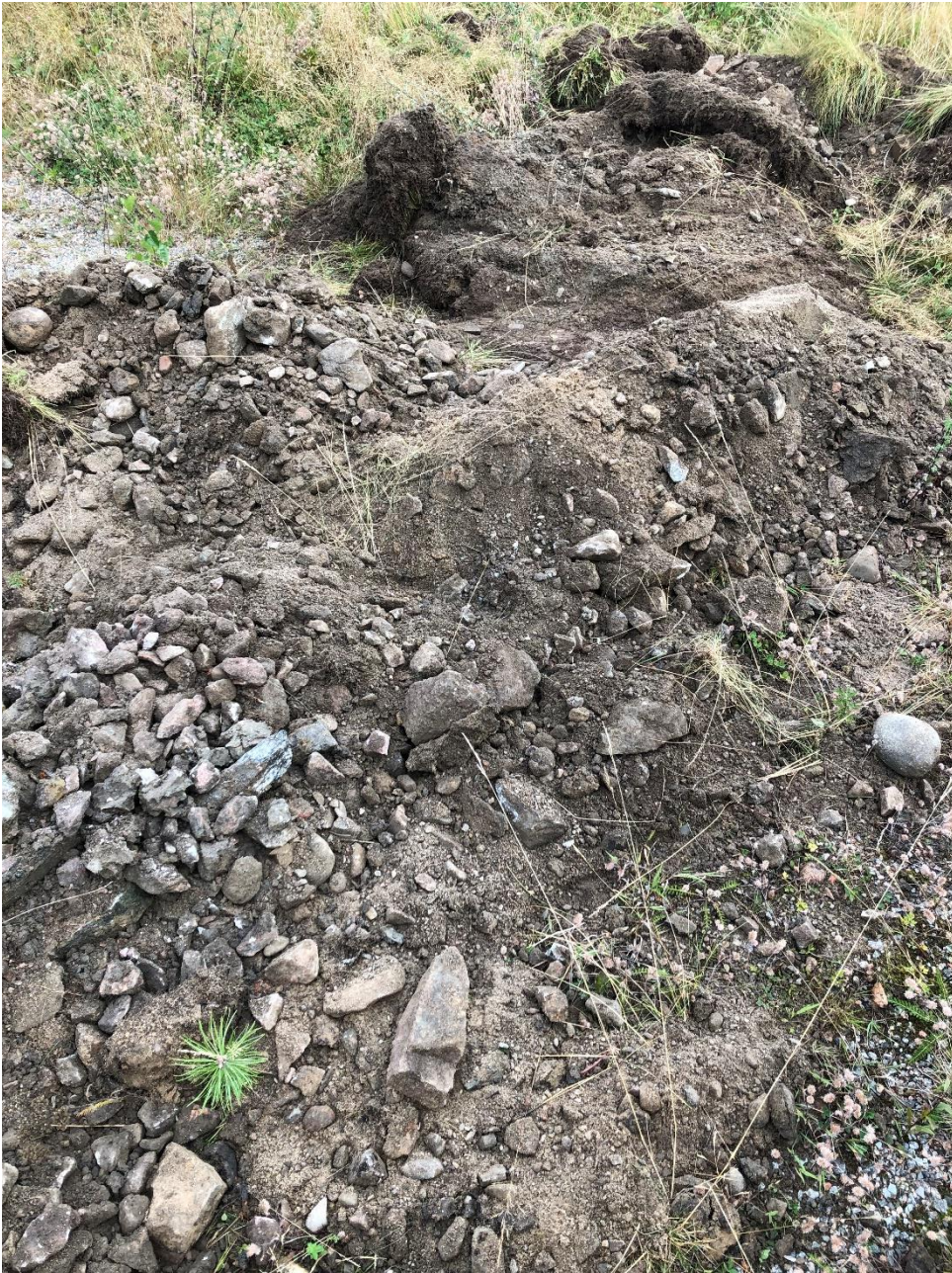
Foto 3. PG1: Blandat sandigt grusigt fyll, stopp på block (1-1,10 m).
