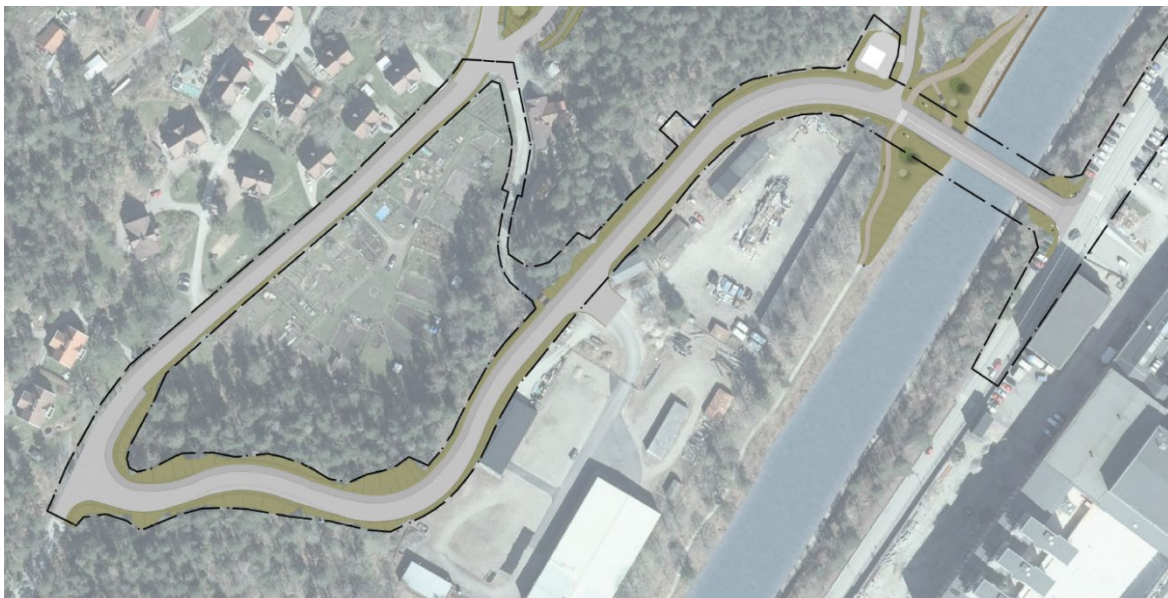
Figur 3. Illustration på ny bro, väg och gång- och cykelvägar samt teknikhus. (Illustration från Trafikverket)
