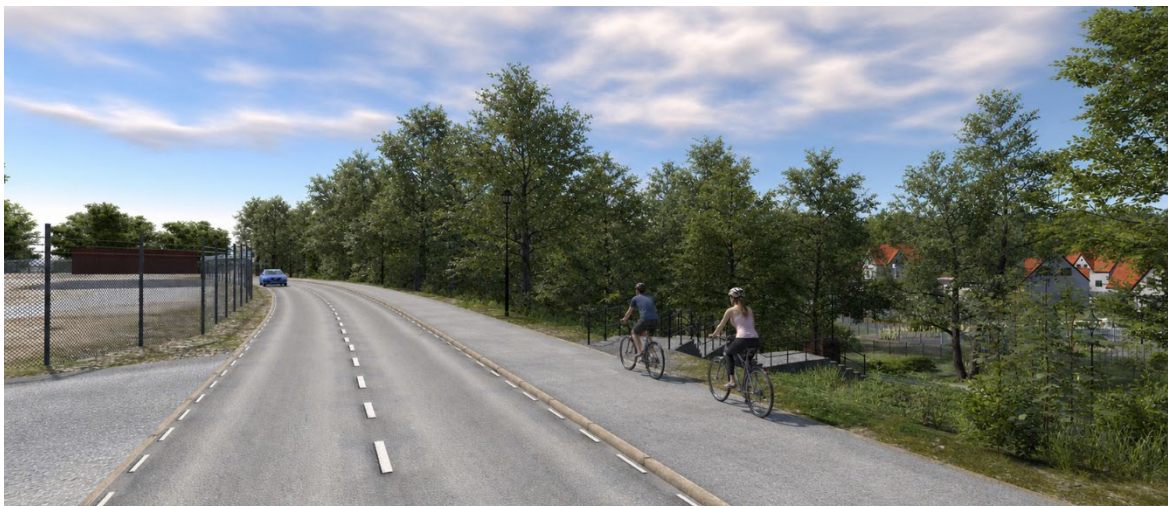
Figur 7. Illustration över ny väg från Västergärdetbron till Åkersbergsvägen. Vattenfalls upplag till vänster och slutningen ner mot koloniområdet till höger i bild. Bilvägen är 5,5 meter bred och gång- och cykelvägen 3 meter. Till höger i bild ses också förslag på trappa i nuvarande tillfartsvägs sträckning. (AI-redigerad bild från Trollhättans stads 3D-modell)
