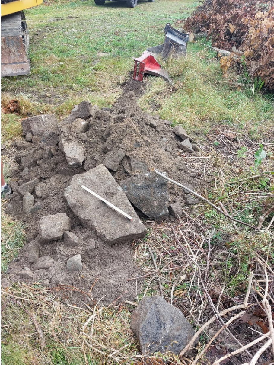
Figur 2. Sprängstensfyllningen utgörs huvudsakligen av sten och block.
