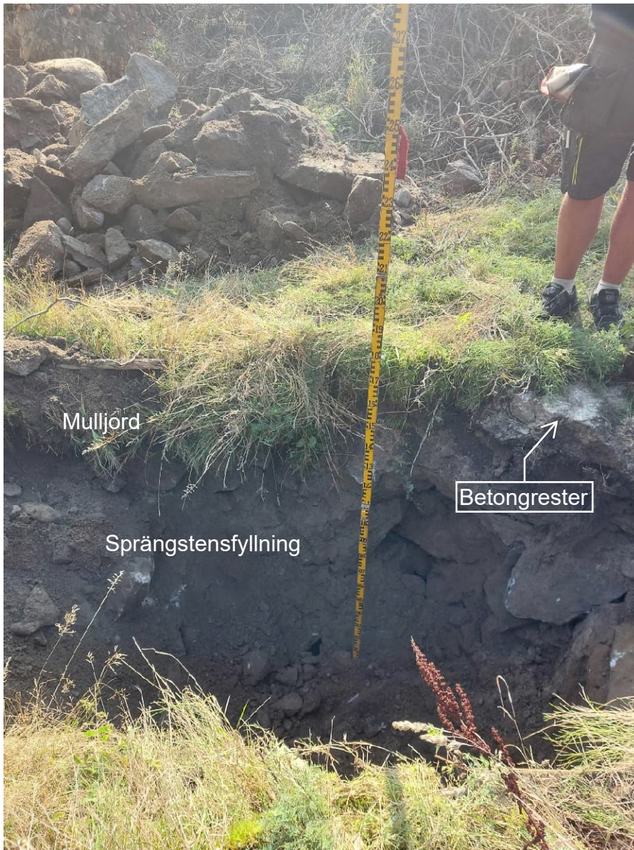
Figur 1. Jordlagerföljd (fältbedömning). Under mulljorden noterades inga skiktgränser.
