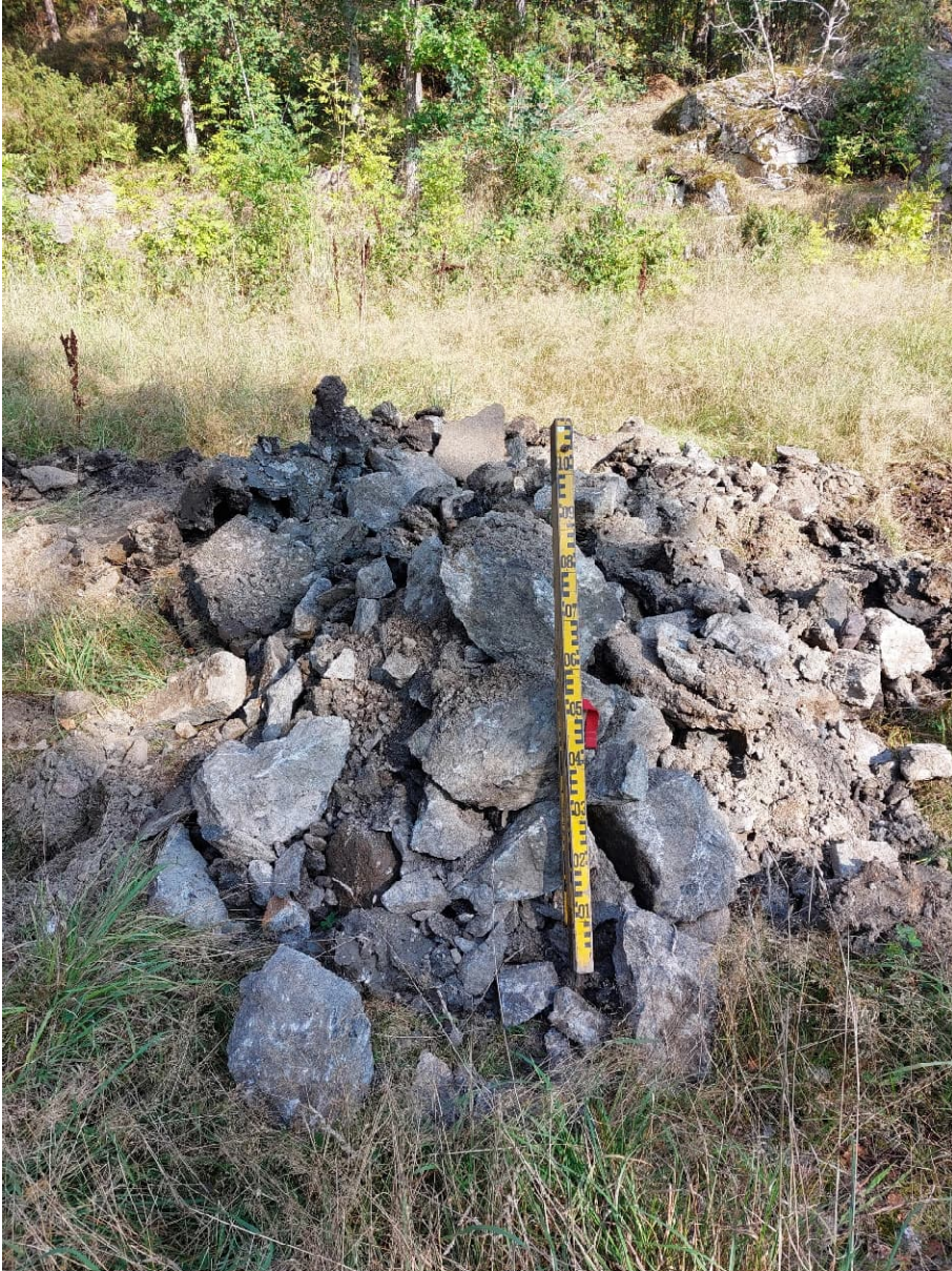
Figur 2. Sprängstensfyllningen utgörs till största delen av sten och block.
