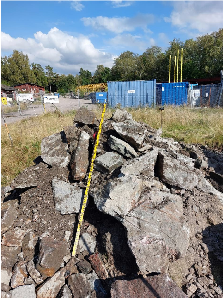
Figur 3. Sprängstensfyllningen bedöms utgöras av ungefär lika delar block 200 < d < 630 mm och block 630 < d mm.
