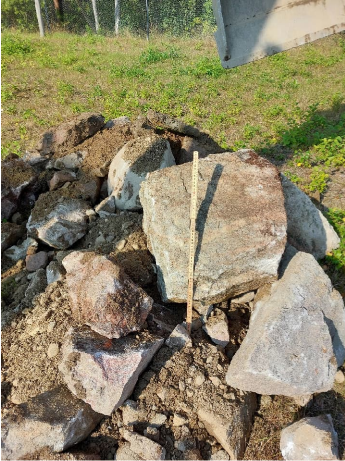
Figur 3. Påträffade block är mindre än d=630 mm.
