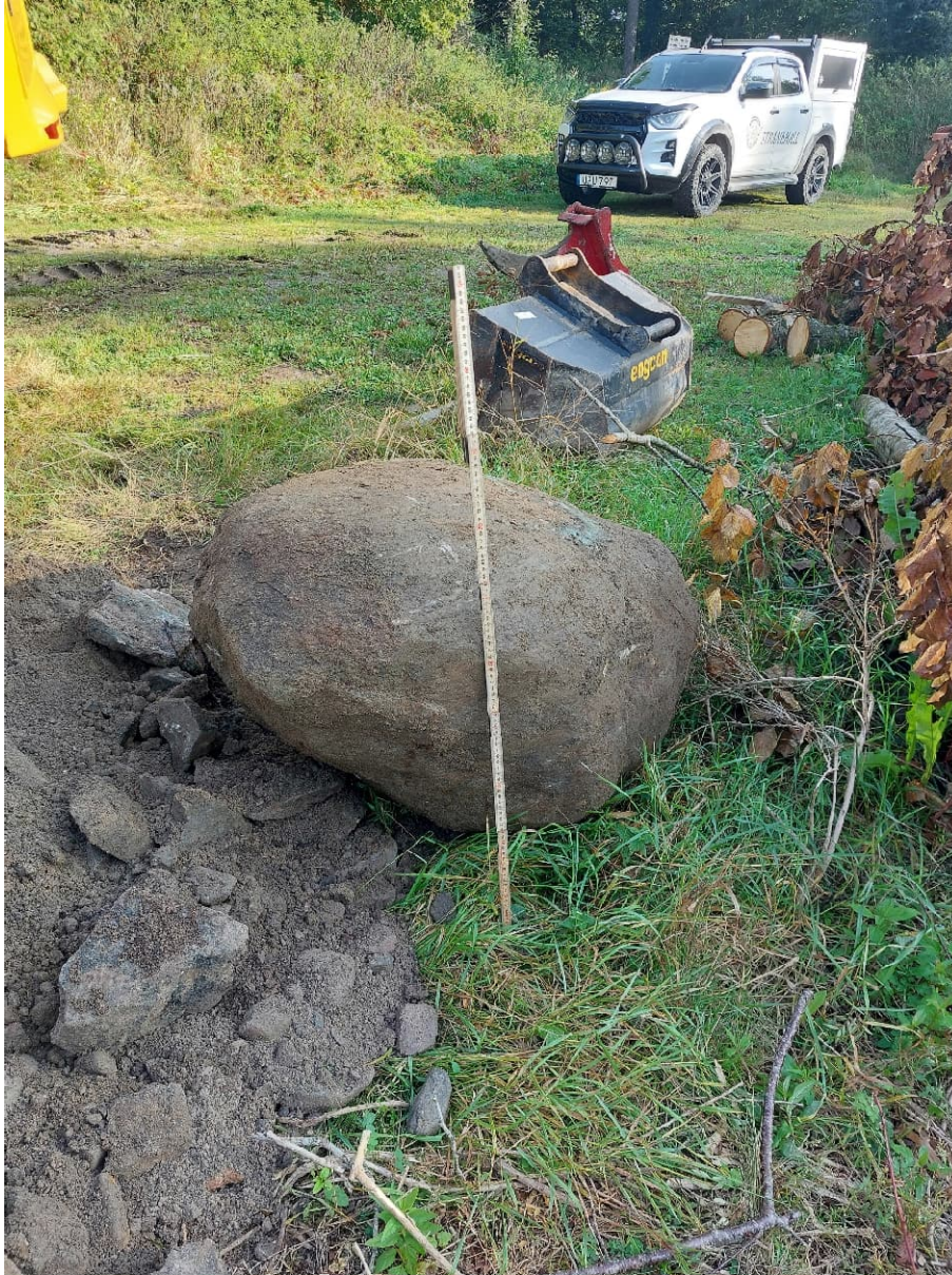
Figur 3. Endast ett block större än d=630 mm påträffades. Detta bedöms vara ett naturligt block som tillfogats sprängstensfyllningen.
