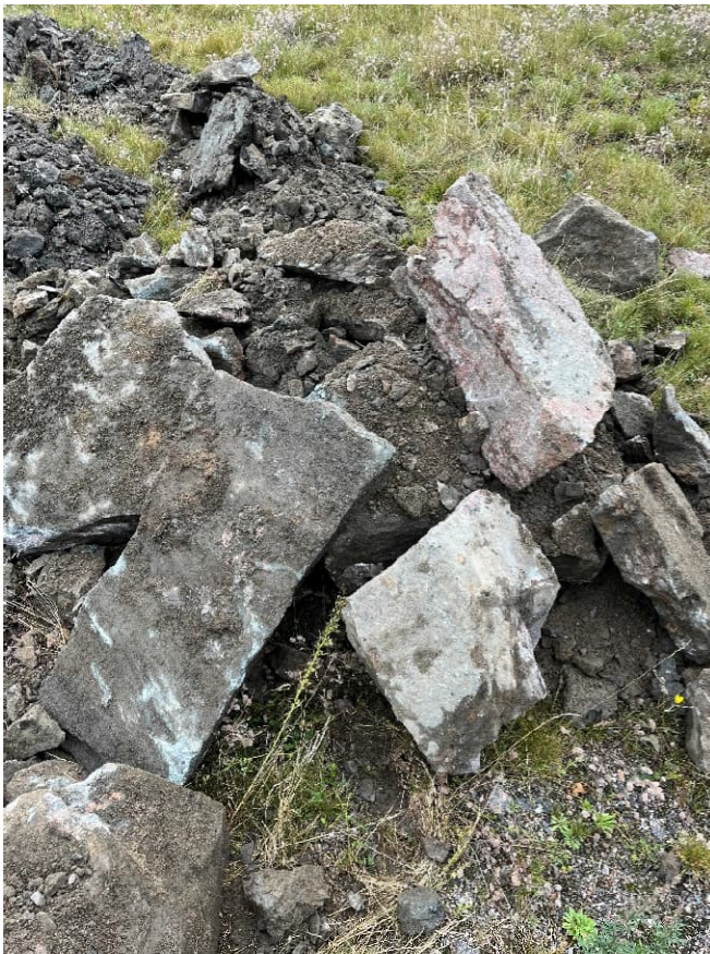
Figur 3. Block ( 200 < d < 630 mm). Inga större block påträffades.
