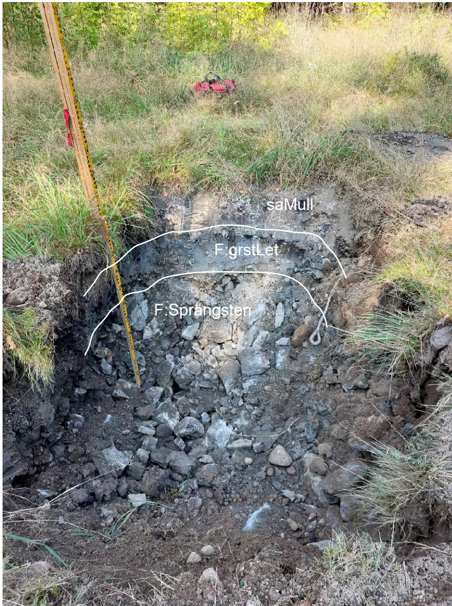
Figur 1. Jordlagerföljd enligt fältbedömning. I gropens högra sida påträffades metallskrot.
