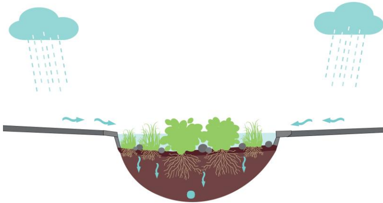
Figur 5: Biofilter med dräneringsrör anlagt i botten.
