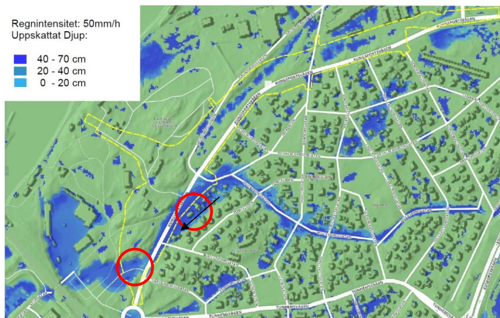
Figur 13: Lågpunktskartering inom detaljplanen utifrån befintliga förhållanden vid ett regnscenario med 50mm/h, Scalgo 2019-05-23. Gulsträckt är planområdesgräns. Svart pil visar flödesriktning. Det röda området visar på ett kritiskt område där bostadsbebyggelse är planerat, samt vid befintliga bostäder.
