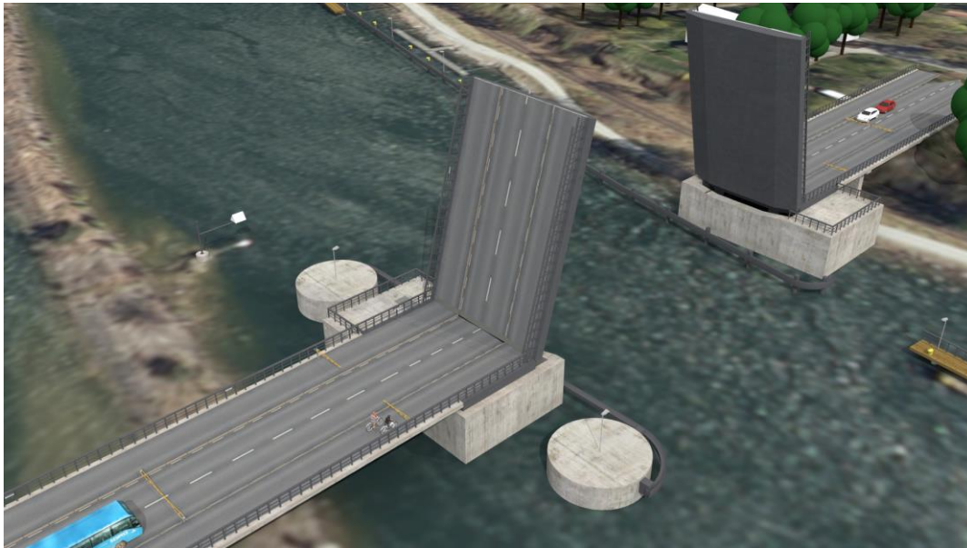
Princip för dubbelklaffbro
