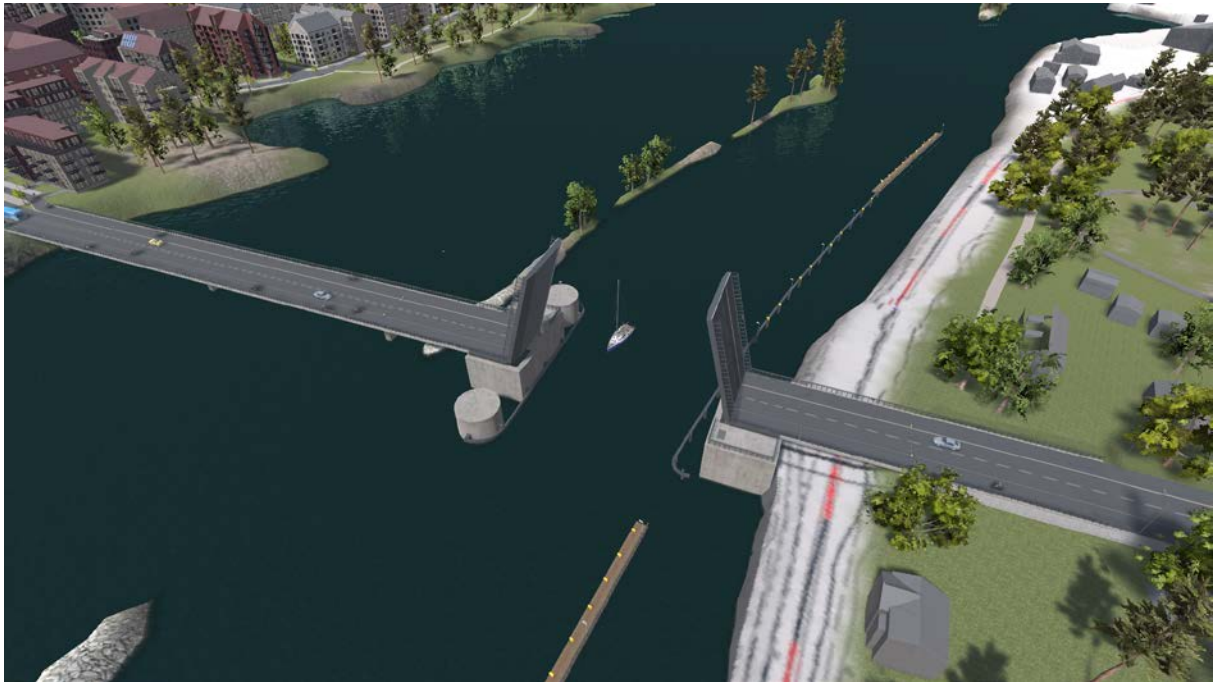
Princip för dubbelklaffbro
