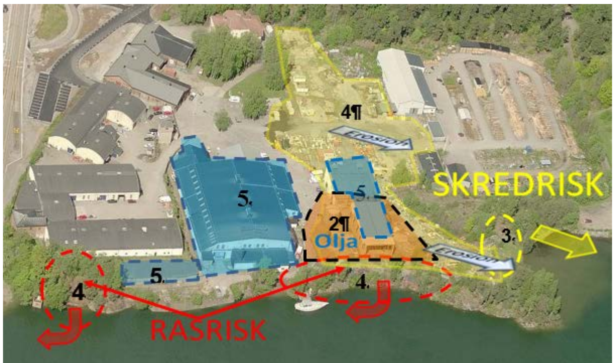
Figur 3 Illustration av riskbilden vid Källstorps industriområde innan sanering. Utöver de numrerade objekten är hela området utfyllt med stora mängder förorenade massor.
