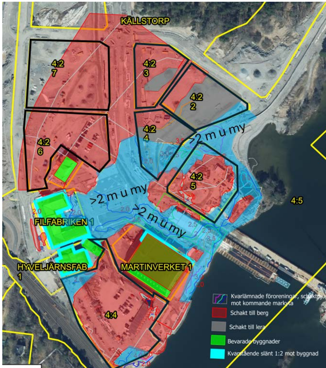
Figur 3 Illustration av saneringsschaktens botten. I röda områden har schakten nått bergets överyta, inom gråa ytor lera medan schaktbotten inom blåa ytor består av kontaminerade fyllnadsmassor.
