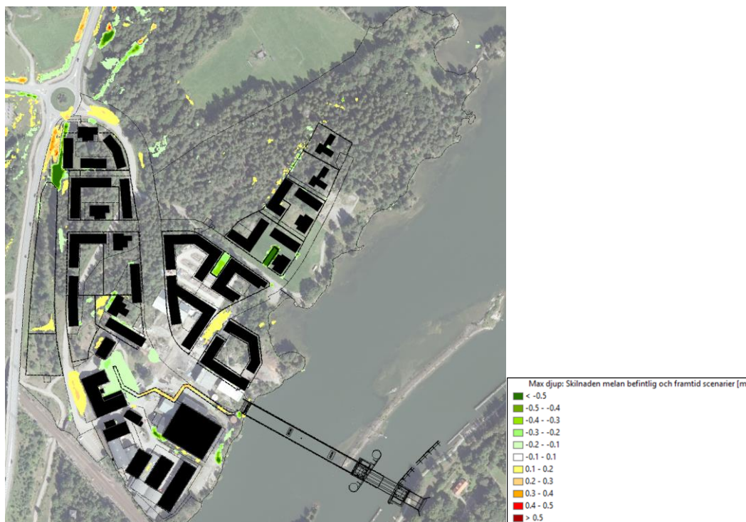
Figur 11. Beräknat vattendjup vid ett klimatanpassat 100-årsregn vid jämförelse mellan befintlig situation och efter genomförd nybyggnation inom planområdet.
