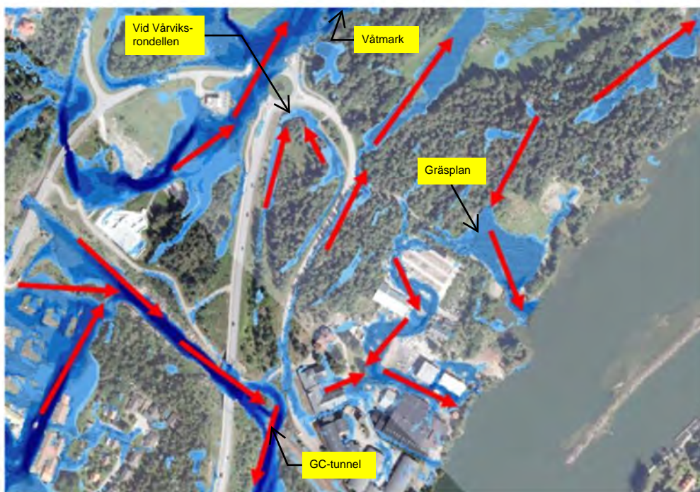
Figur 4. Ytliga flödesvägar (rödmarkerade pilar) vid ett klimatanpassat 100-årsregn - befintlig situation.
