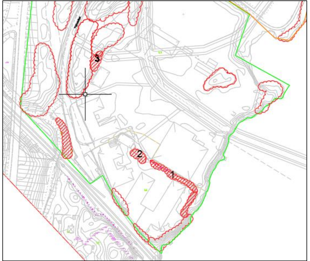
Figur 7 Bergområden med potentiella stabilitetsproblem visas med skrafferade, numrerade moln. Övriga områden med berg i dagen visas med ofyllda moln.
