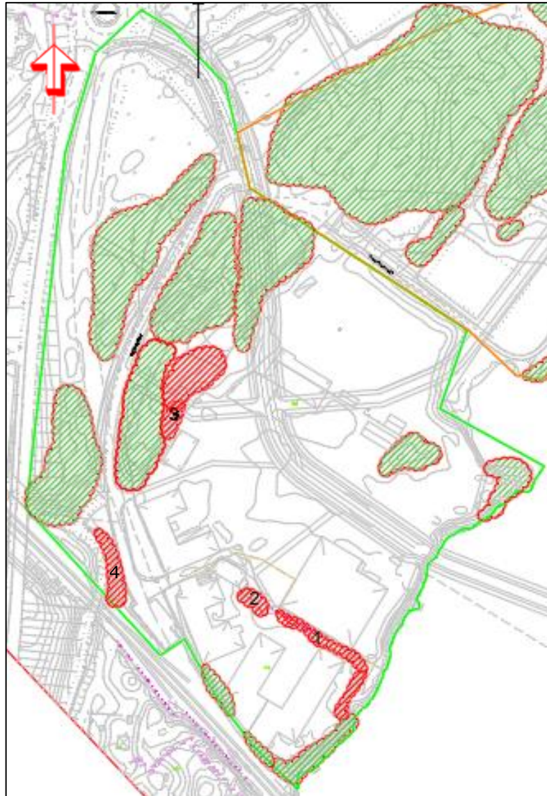
Figur 5 Områden med berg i dagen visas med grön respektive röd skraffering. Rödmarkerade områden beskrivs mer i detalj i kapitel 3.3
