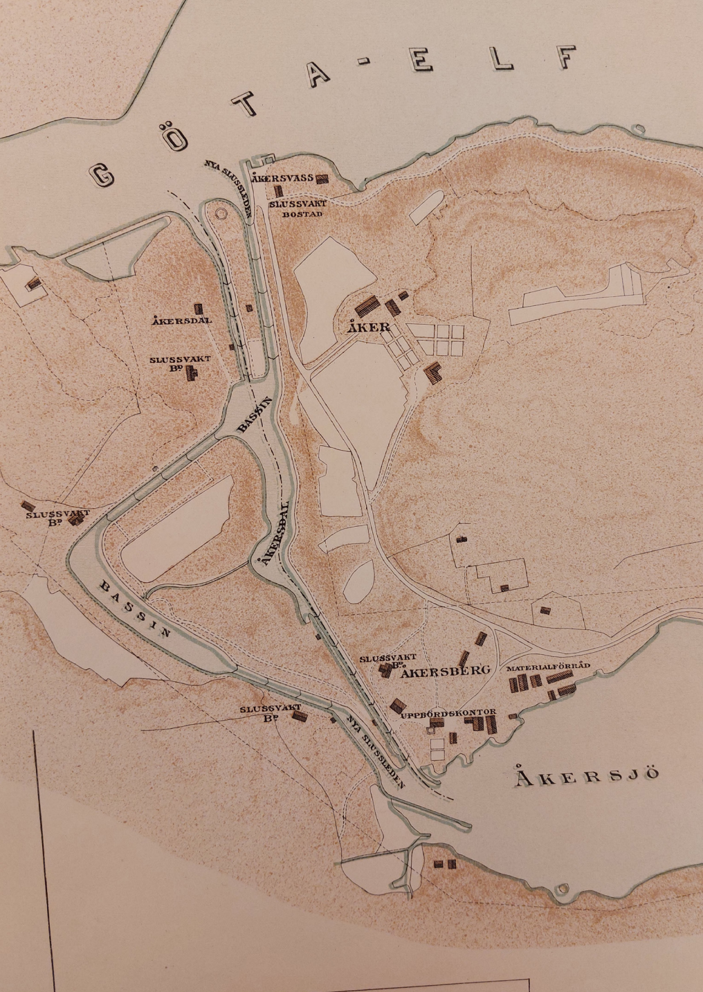
Figur 91. Kartan till vänster från sent 1800-tal visar slussområdet före tillkomsten av 1916 års slussled. 1800-års slussled är streckad i kartan. De två slusslederna från 1800-talet användes parallellt fram tills att nuvarande slussar togs i bruk. Till höger samma område på nutida flygfoto. Av fotot framgår att slussarna och bassängerna är desamma förutom nuvarande Höljan som tillkom med nuvarande slussled. På 1800-talskartan har en del av bebyggelsen vid Åkersberg tillkommit. Av bebyggelsen vid Åkers dal finns idag bara grunderna kvar.
