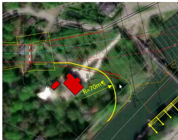
Figur 30 Den gula kurvan visar en ungefärlig gräns för bergskärningen som kommer att utgöra den nya slussmynnings södra strand. Olidans mangård och uthus är markerade med rött.
