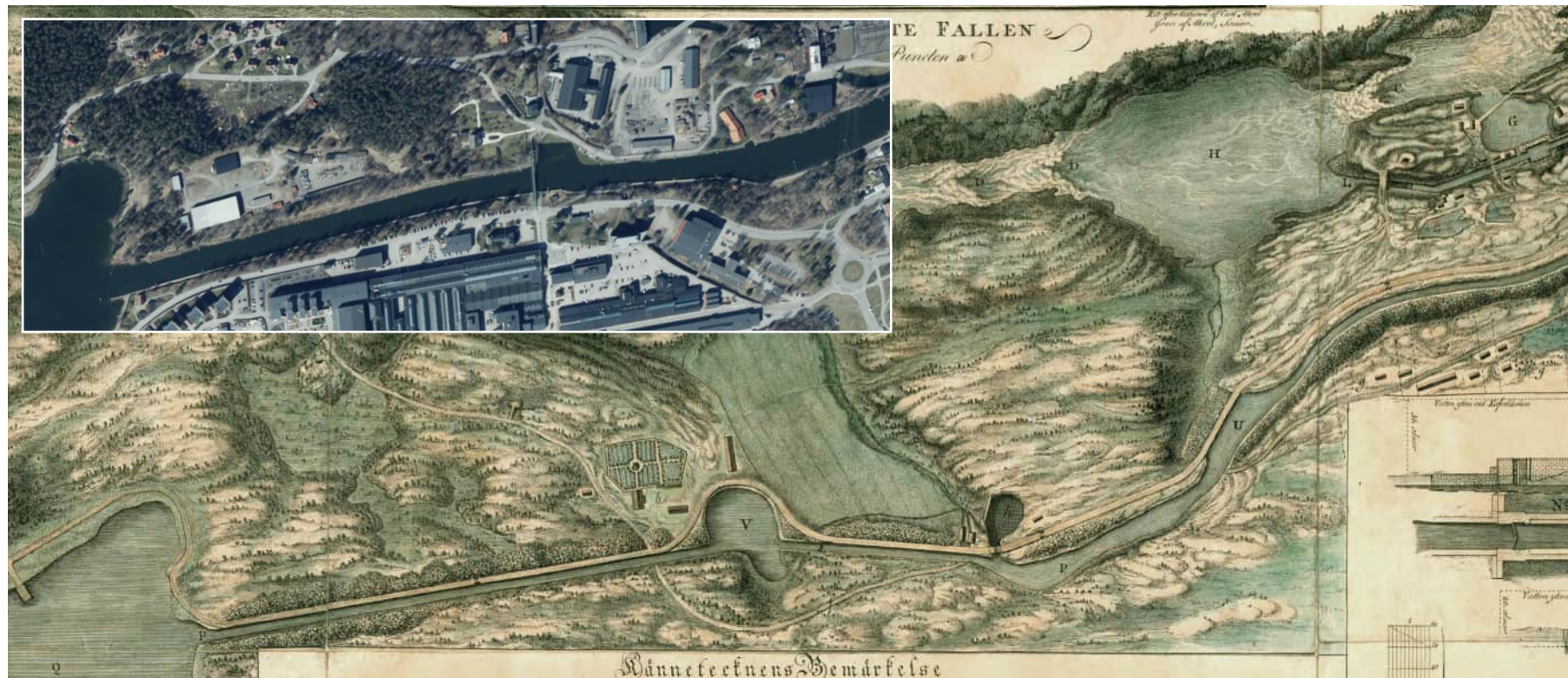
Figur 74. Södra delen av Bergkanalen, år 1800 (Krigsarkivet), med nutida ortofoto infällt. Kanalen har breddats men med bibehållen sträckning. Vissa strukturer som Olidebassängen och infart mot dockan finns kvar idag. Olidans gård med trädgård syns i båda illustrationer. Dockan byggdes om kring 1914 och är idag ersatt av en byggnad. Strukturer i kajen visar var den låg.
