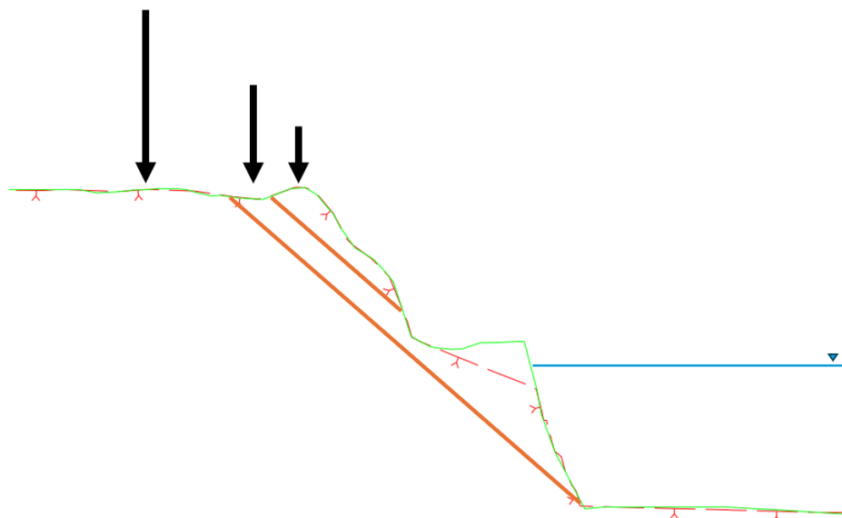
Figur 9. Illustrativ bild för grundläggning öster om bergkanalen. De orangea linjerna illustrerar foliationsparallella potentiella glidplan och de svarta pilarna illustrerar hur grundläggningskapaciteten (pilens längd) beror på avståndet till släntkrönet.
