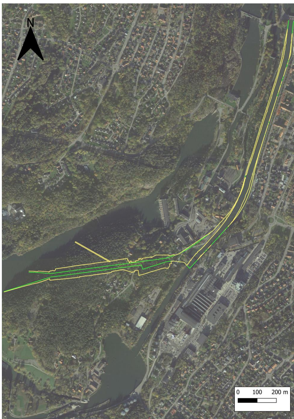
Figur 3. Översiktskarta med planerad utbredning av bergschakt inom slussområdet och bergkanalen markerade i gult. Planerad farled markerad i grönt.
