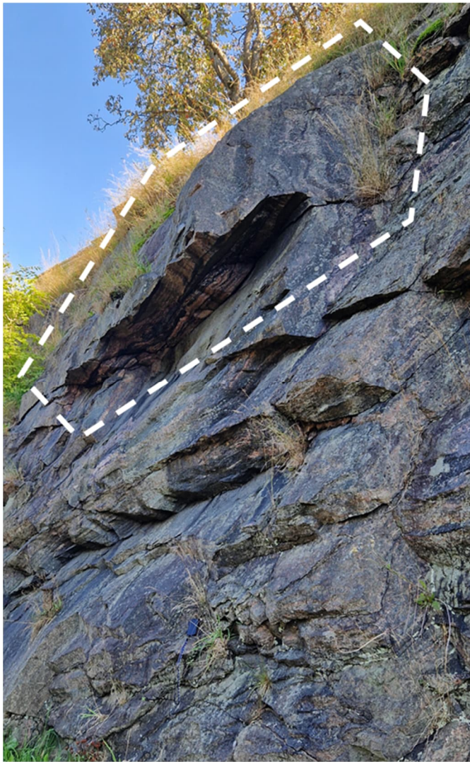
Figur 16. Block 10, markerat med vit streckad linje, är cirka 3x2x1 m stort.
