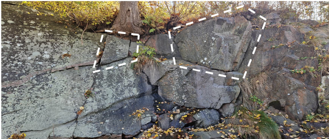
Figur 33. Block 24 och 25, markerade med vit streckad linje, är cirka 1x2x1,5 m respektive 1x1x0,2 m stora.
