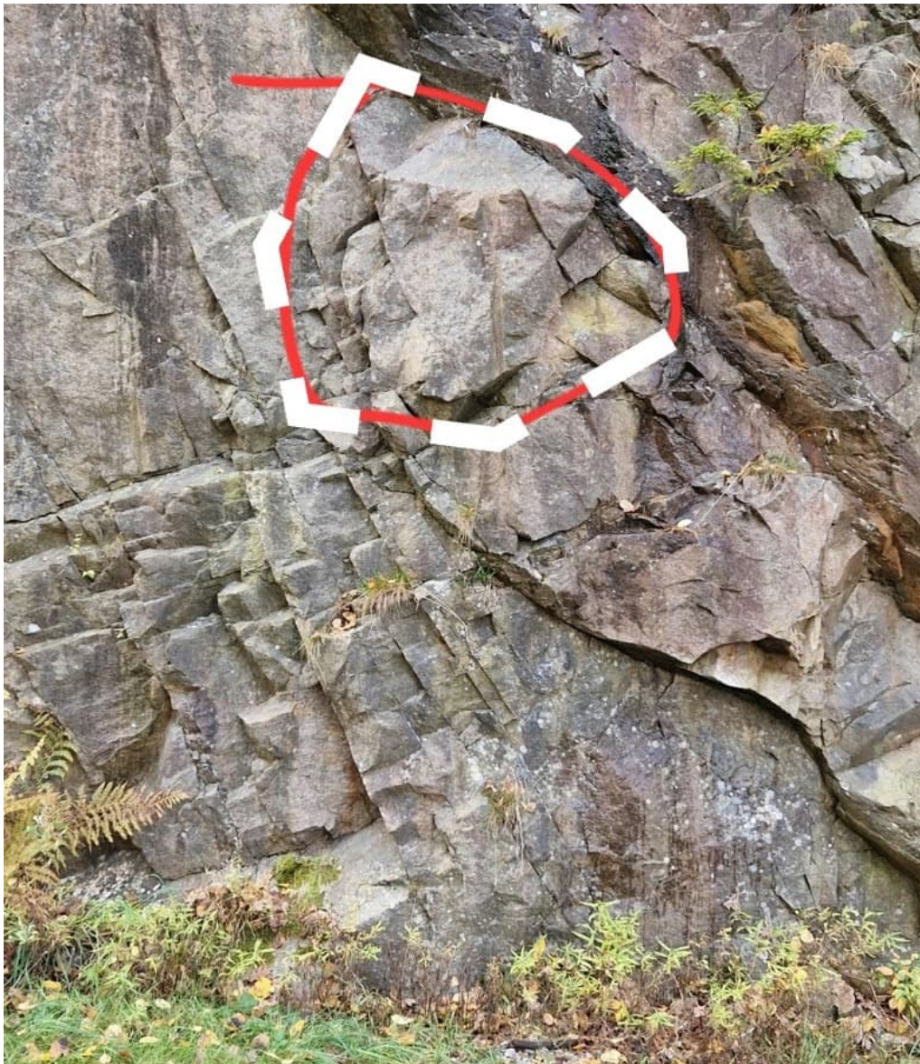
Figur 26. Block 18, markerat med vit streckad linje, är cirka 2x1x0,5 m stort.
