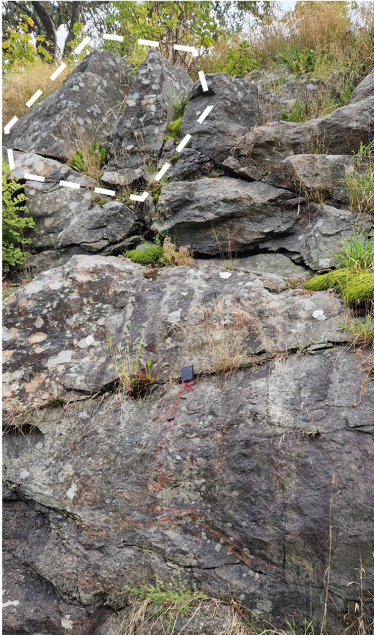
Figur 10. Block 4, markerat med vit streckad linje, utgörs av två sammanhängande instabila block som båda är cirka 1x1x1 m stora.
