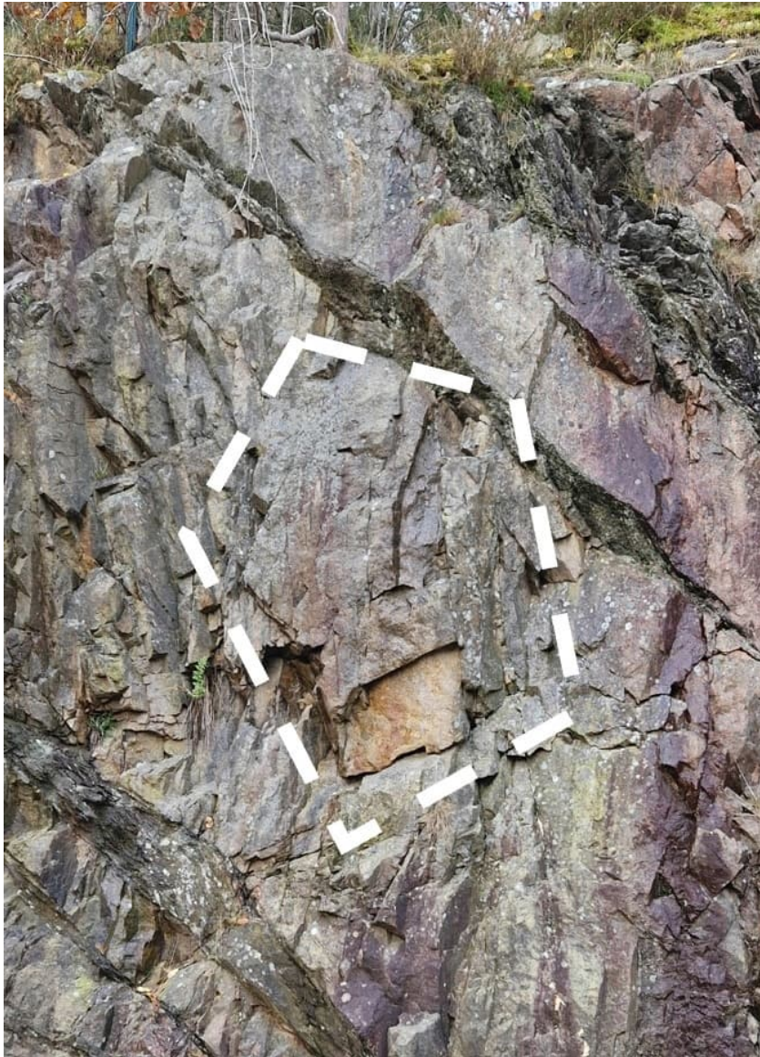
Figur 25. Block 17, markerat med vit streckad linje, är cirka 2x1x0,5 m stort.
