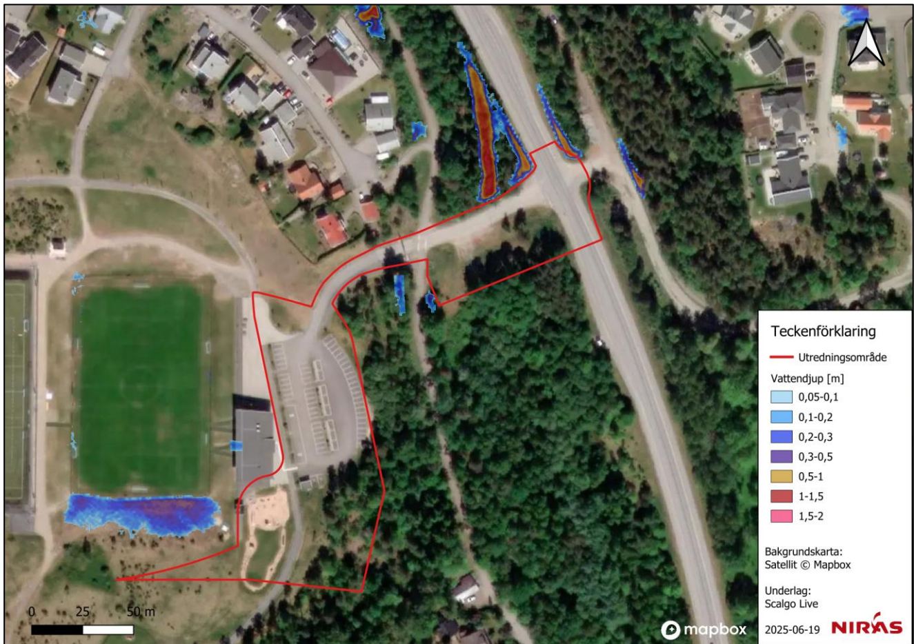
Figur 11. Skyfallsmodellering för utredningsområdet (röd markering) vid 50 mm regn, modellering utförd i SCALGO Live.
