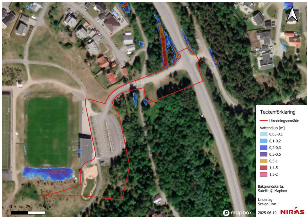
Figur 18: Skyfallsmodellering för utredningsområdet inom röd markering vid 50 mm regn (Dagvatten- och skyfallsutredning 2025).
