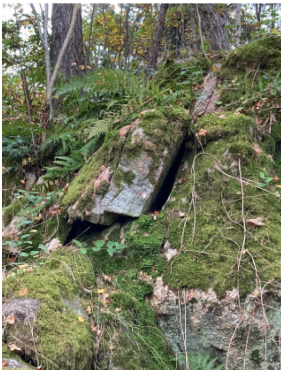
Figur 14. Exempel på lösa stenar och blockar som behöver säkras. Bilder hämtade från den geotekniska utredningen. Bohusgeo 2021-01-28
