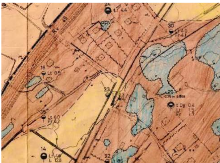
Utdrag ur geoteknisk karta/borrplan. VIAK 1968, arbetsnummer 64.8525-1
