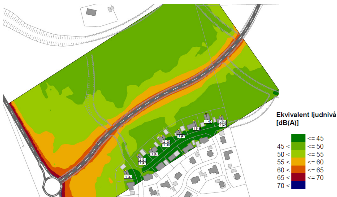
Figur 31: Bullerberäkning för infartsväg, alternativ A. Ljudutbredning 1,7 meter över mark, ekvivalent ljudnivå.
