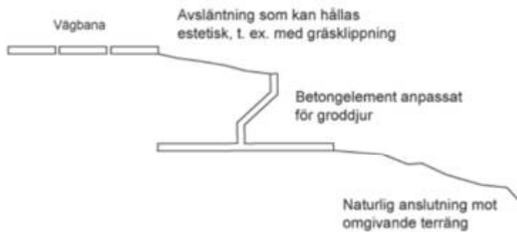
Figur 9.6-7 Principskiss över en ledarm med överhäng i tvärsnitt. Övergången hindrar salamandrar såväl som andra groddjur från att ta sig upp på vägen.
