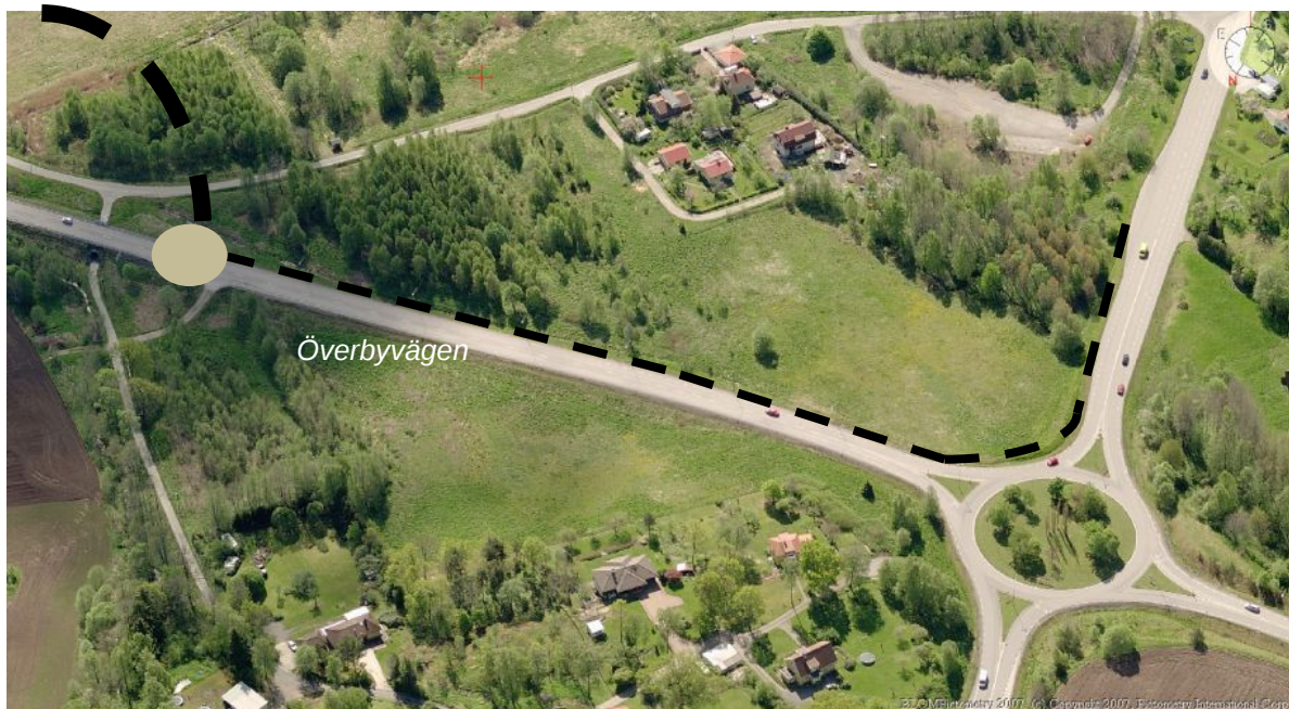
Ny cirkulationsplats på Överbyvägen. Avsvängande högerkörfält anläggs i Nybergskullarondellen fram till den nya cirkulationsplatsen.
