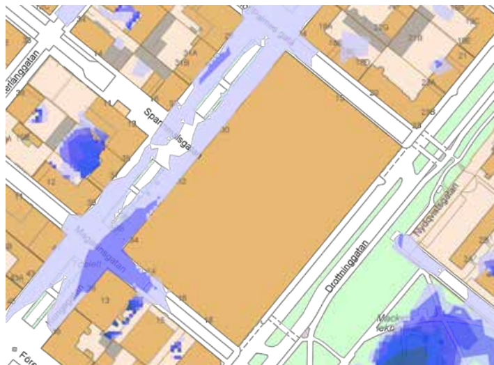
Översvämningsytor vid ett skyfall (Sweco 2014)
