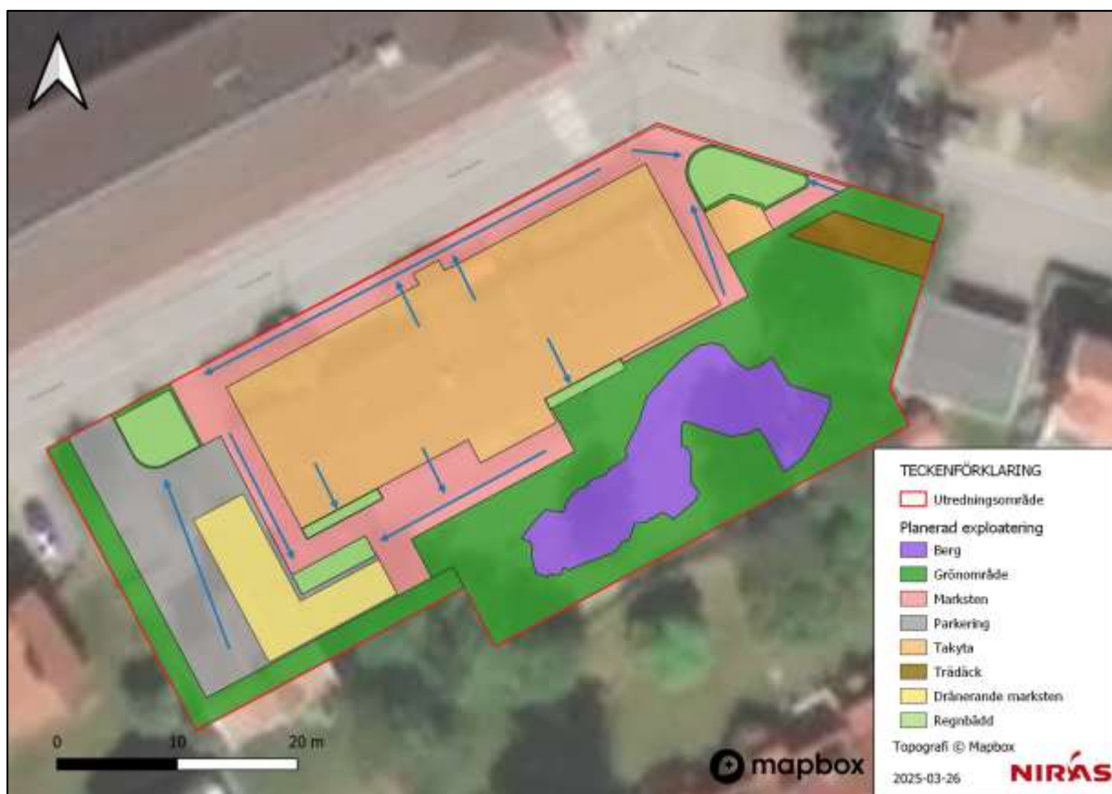
Figur 8.1 Situationsplan med markering för tilltänkta regnbäddar med ungefärliga rinnvägar markerat med blåa pilar.
