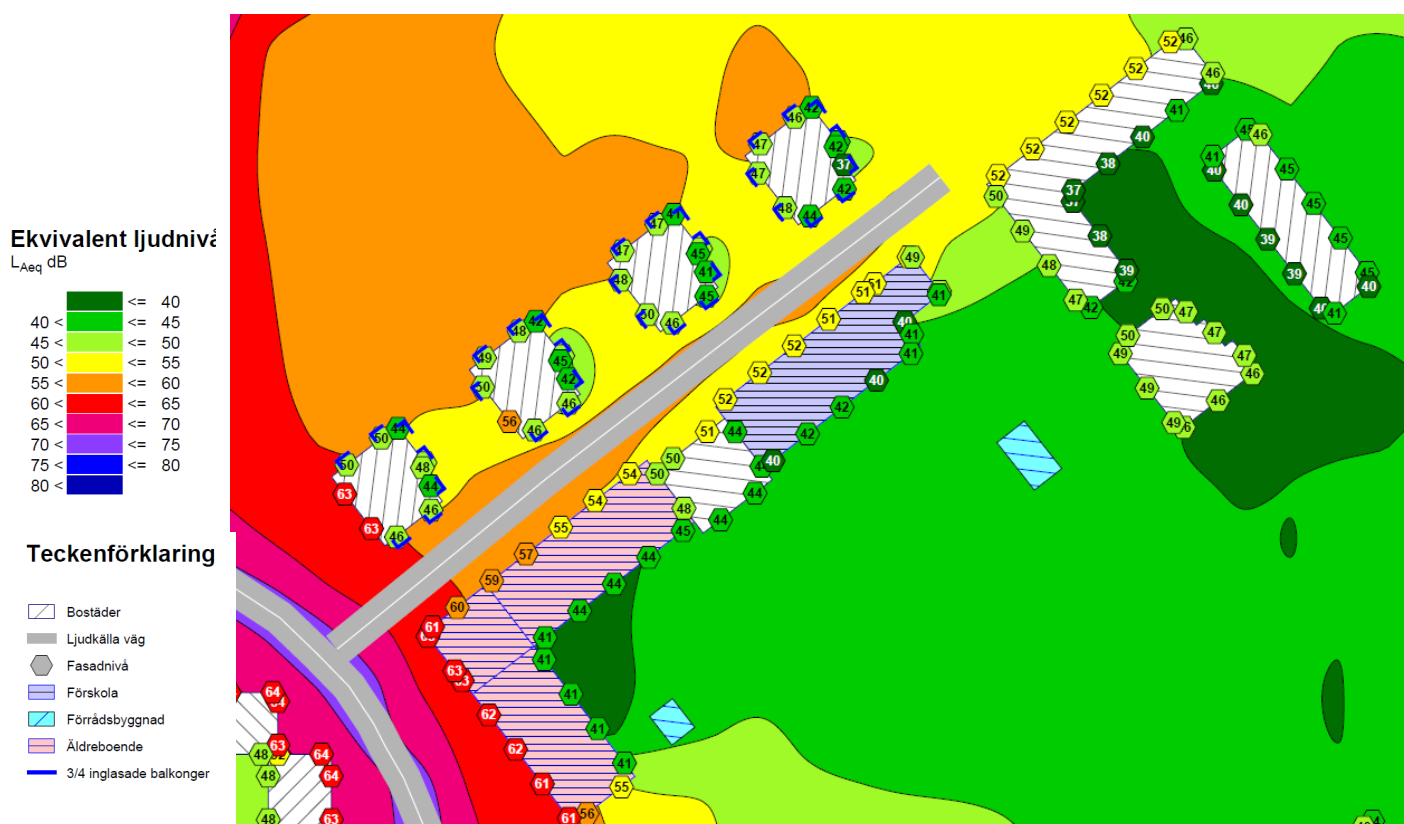
Figur 26. Bullerberäkningar för ekvivalenta ljudnivåer år 2040. I beräkningarna har punkthusen försett med balkonger som är inglasade till 75%. Akustikverkstan 2021-01-12
