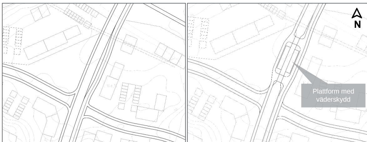
Figur 27. Utformningsförslag ny busshållplats vid torgytan centralt i Hults höjd.
