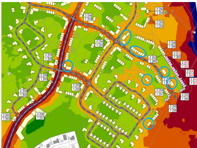
Figur 3. Inringade hus som har inte någon eller väldigt liten yta i anslutning till huset där riktvärdena för uteplats klaras utan särskilda bullerskyddsåtgärder
