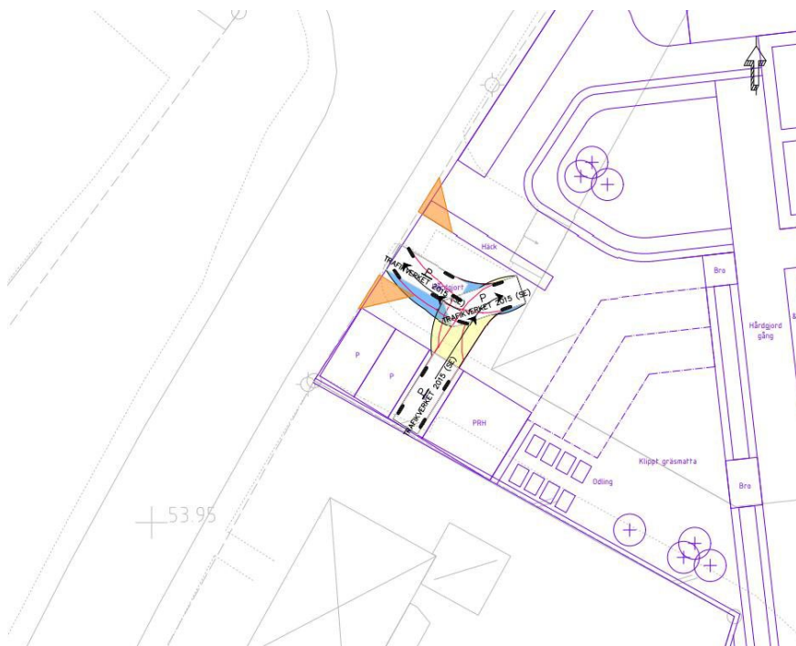
Bild 13 Från trafikutredningen. Utfrt från parkeringen på gården till Nysätersvägen.
