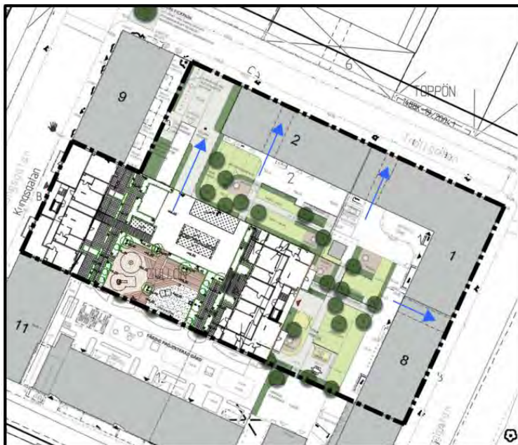
Figur 22 Blå pilar är flödesvägar för yttlig avrinning vid stora regn.
