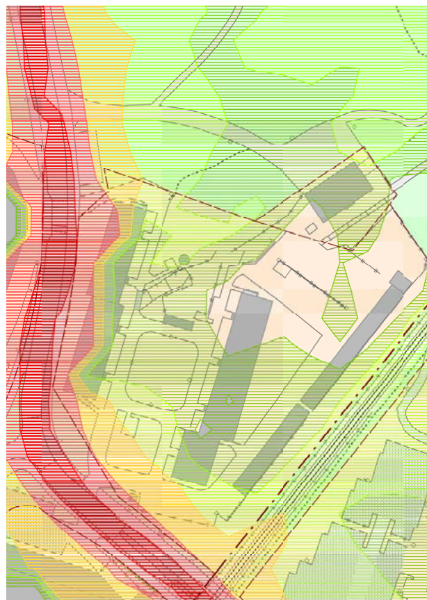
Utdrag ur tidigare genomförd vägbullerkartläggning (Bullerkartläggning Trollhättans stad, ÅF 2017-06-16), ekvivalent ljudnivå. Orangea områden visar 55-60 dBA, röda områden 60-65 dBA och mörkröda 65 dBA och högre
