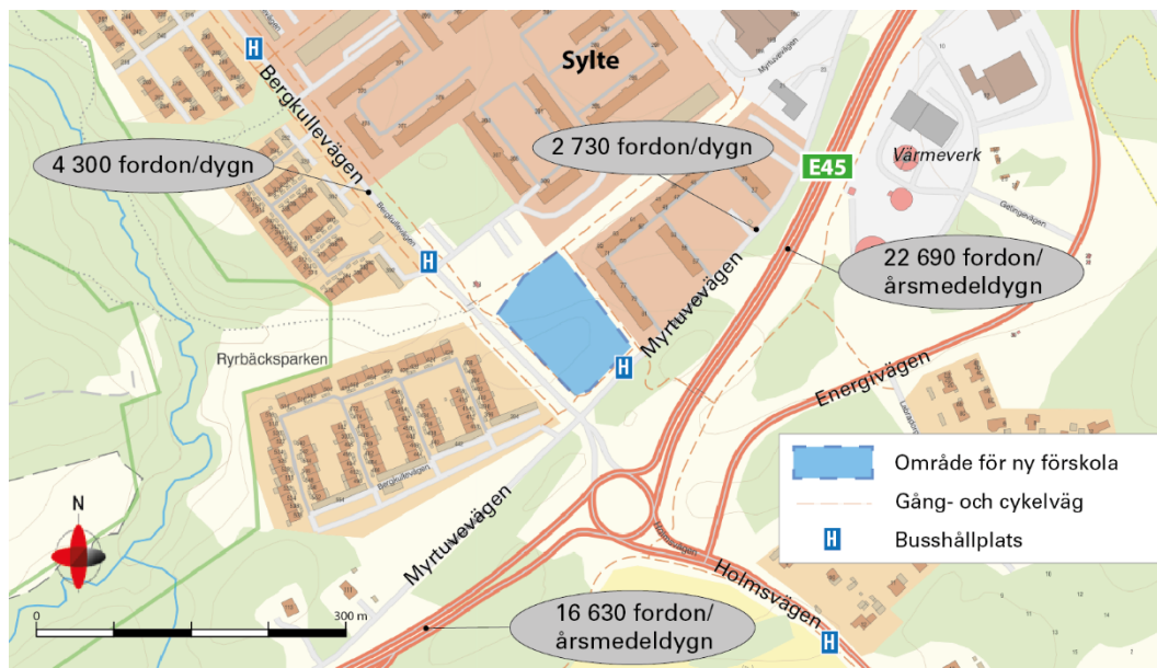
Figur 3. Befintliga trafikflöden, mätår 2018-2019. Källa: Trafikverket och Trollhättans Stad.
