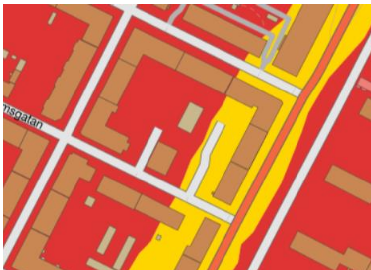
Bild 12. Kartan visar att större delen av planområdet består av ett tunt lager morän ovan berg, vilket är de röda områdena i kartan. En del av Eken 9 består av glacial lera, det gula området.
