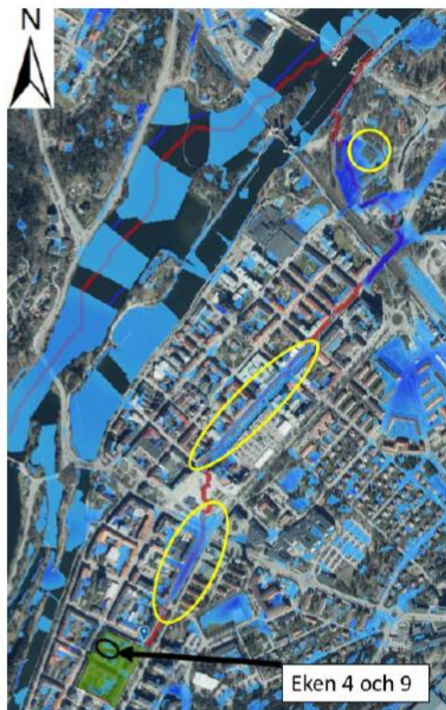
Bild 11. Visar en karta över ytvattnets flödesriktning.
