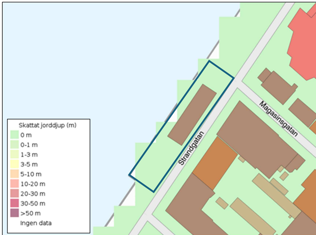
Figur 6. Förväntat jorrdjup enligt geologiska kartbladet, blå polygon markerar ungefärligt läge för undersökt område, bild hämtad 2026-04-13. Källa: SGU:s kartvisare.
