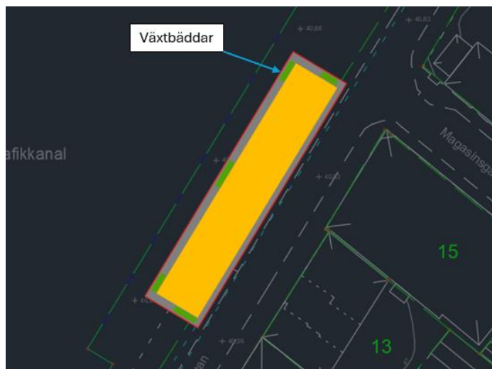
Figur 12. Föreslagen dagvattenhantering för rening inom planområdet. Gul yta representerar byggnad, gröna ytor illustrerar växtbäddar. Plangräns visas med röd linje.
