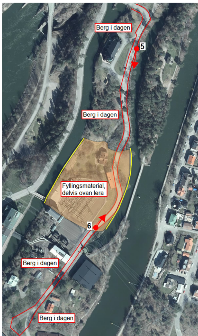
Figur 18. Översikt över bedömda jordlagerförhållanden i längs Kyrkbrovägen inom planområdet samt fotopunkter och fotoriktningar. Orange markering visar område med lera under fyllningsmaterialet. Gula linjer illustrerar stödmurar.
