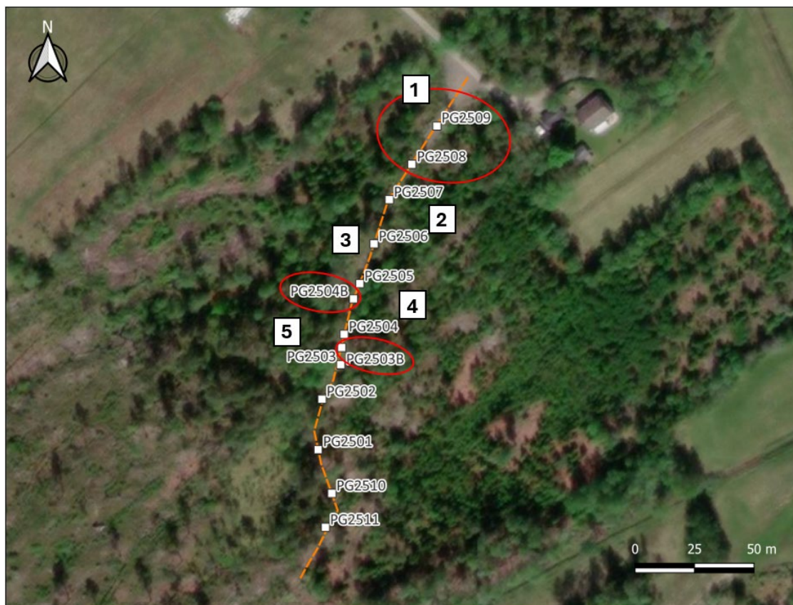
Figur 4. Ungefärlig placering av provgropar markerat med små vita kvadrater. Större kvadrater markerar områden för ytlig samlingsprovtagning invid vägkroppen. Röda cirklar avser gropar med synlig slagg.
