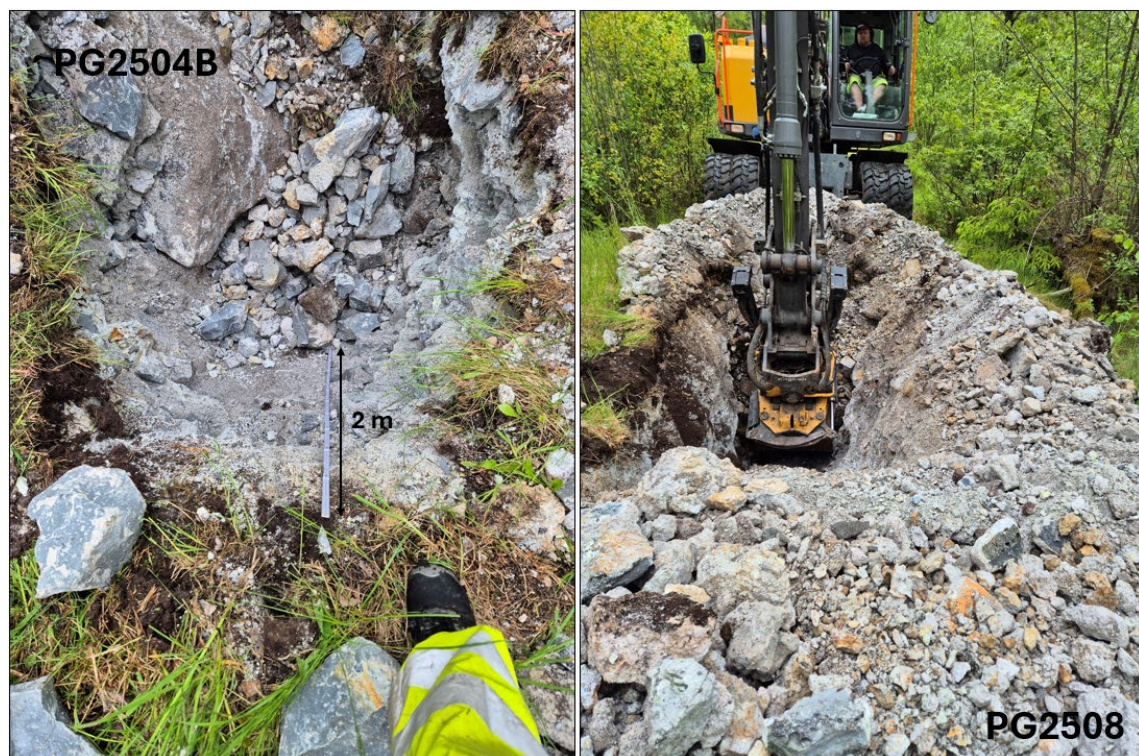
Figur 7. Till vänster PG2504B, extragrop där det återfanns slagg i ytan. Till höger PG2508, med ett 1,8 m mäktigt slagglager.
