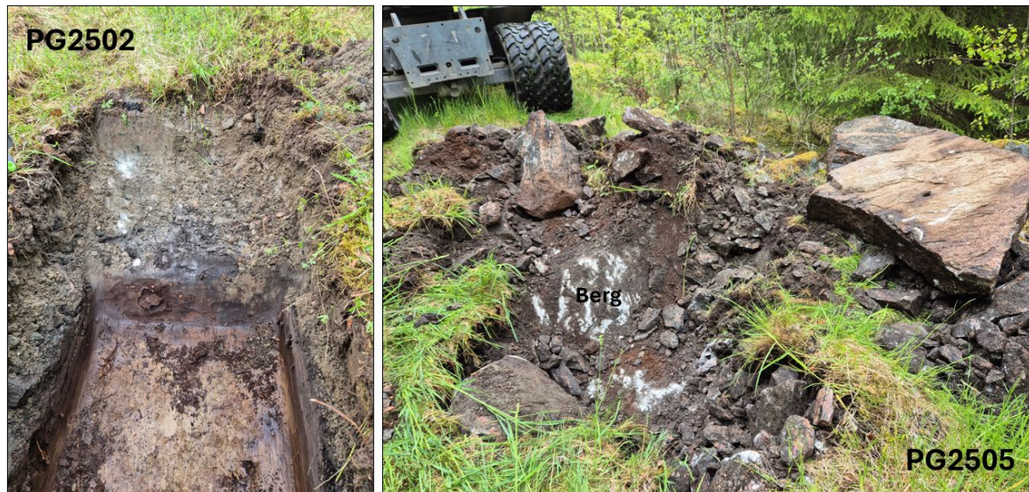
Figur 6. Till vänster PG2502, bergkross på torv och lera. Till höger PG2505 med inslag av block, ytligt berg återfanns från 0,3 m.
