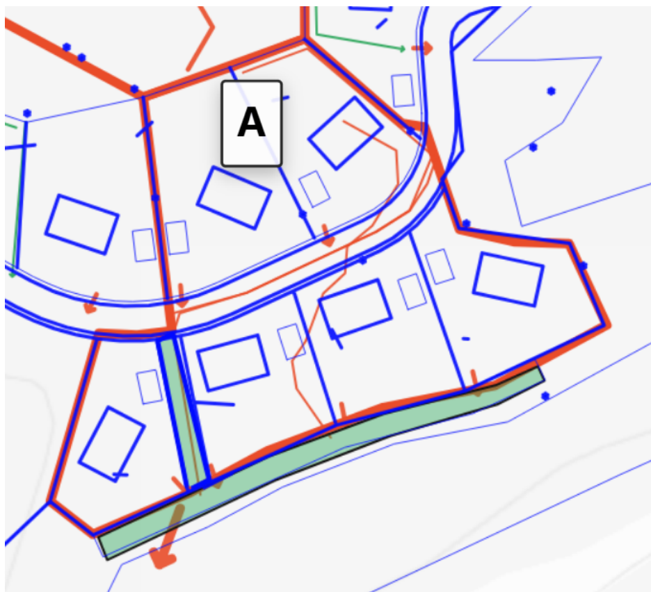
Figur 32. Skiss föreslagen dagvattenhantering. Se även förklaring i kapitel 5.1 "Översiktlig förklaring. Bebyggelseförslaget har uppdaterats efter att skissen upprättades, men de huvudsakliga avledningsprinciperna gäller fortfarande. Se bilaga 6 för aktuellt bebyggelseförslag.
