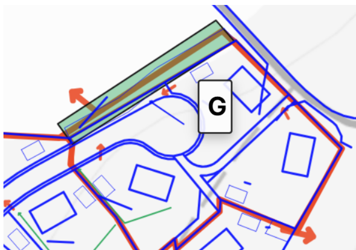
Figur 39. Skiss föreslagen dagvattenhantering. Se även förklaring i kapitel 5.1 "Översiktlig förklaring". Bebyggelseförslaget har uppdaterats efter att skissen upprättades, men de huvudsakliga avledningsprinciperna gäller fortfarande. Se bilaga 6 för aktuellt bebyggelseförslag.
