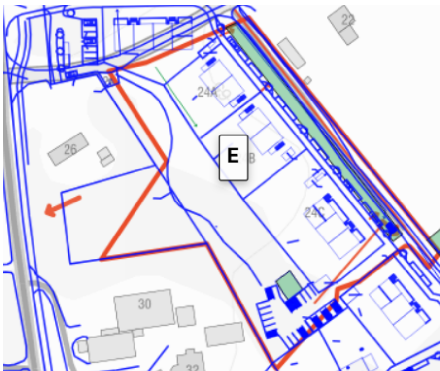
Figur 37. Skiss föreslagen dagvattenhantering. Se även förklaring i kapitel 5.1 "Översiktlig förklaring". Bebyggelseförslaget har uppdaterats efter att skissen upprättades, men de huvudsakliga avledningsprinciperna gäller fortfarande. Se bilaga 6 för aktuellt bebyggelseförslag.
