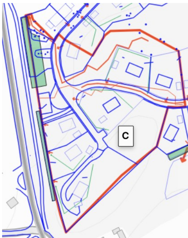
Figur 34. Skiss föreslagen dagvattenhantering. Se även förklaring i kapitel 5.1 "Översiktlig förklaring". Bebyggelseförslaget har uppdaterats efter att skissen upprättades, men de huvudsakliga avledningsprinciperna gäller fortfarande. Se bilaga 6 för aktuellt bebyggelseförslag.
