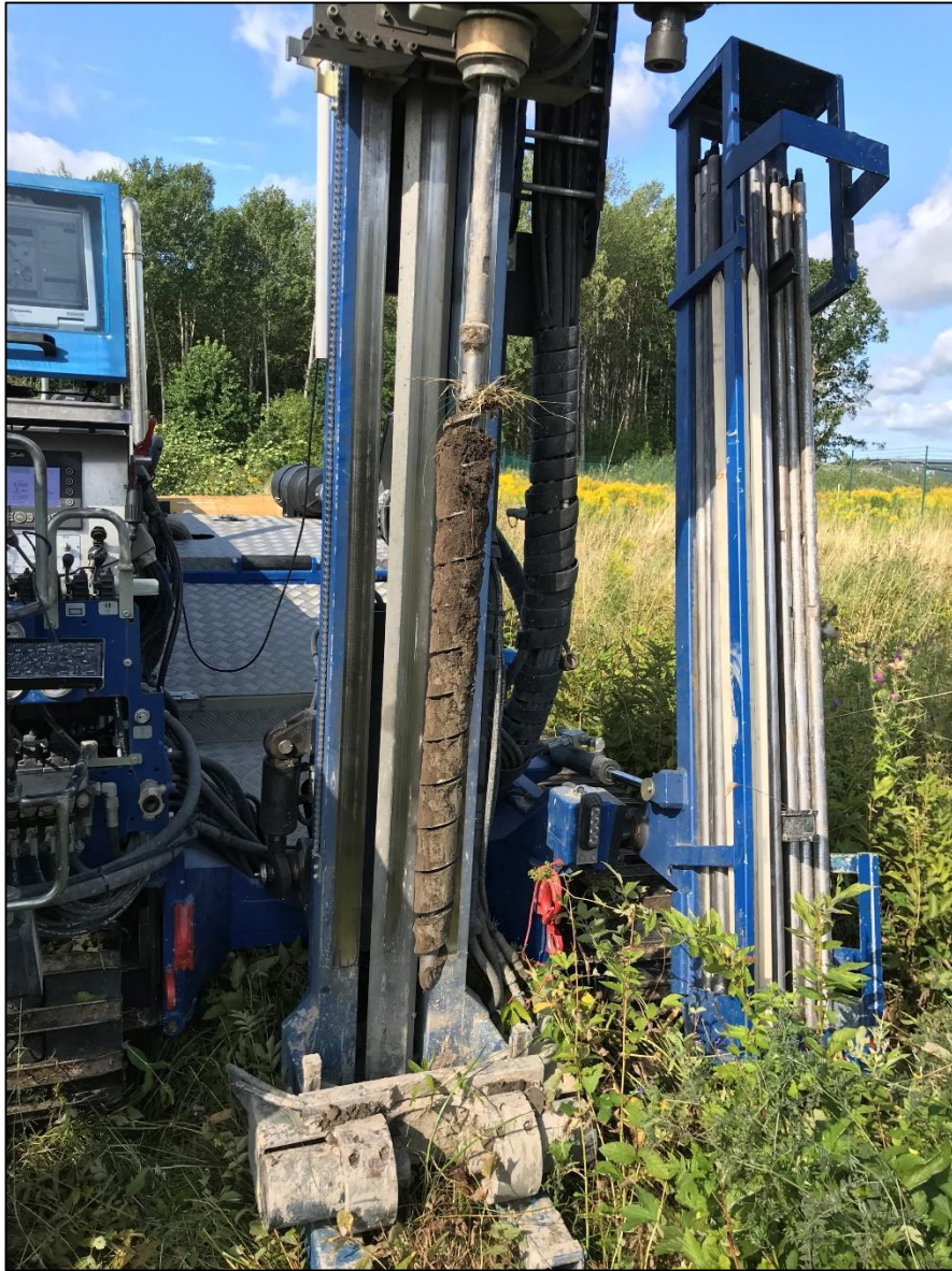
Bild 11: Pp 103, 0-1 m. Provresultat från 0-0,5 m visar inga förhöjda halter av tungmetaller.
