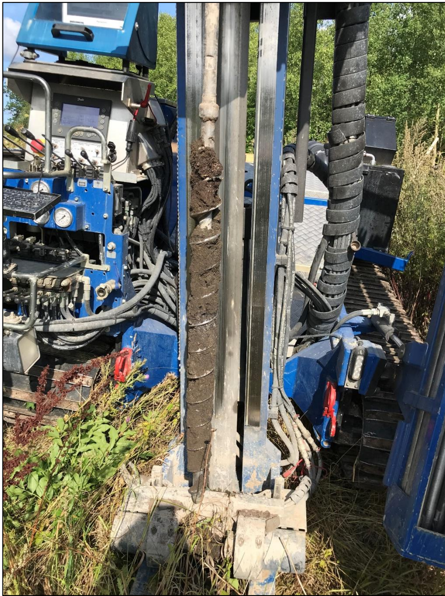
Bild 15: Pp 107, 0-1 m. Provresultat från 0,5-1 m innehåller halter av kvicksilver över nivåer för mindre än ringa risk, halter av bly, kadmium zink PAH-L och aromater C10-C16 över KM, halter av arsenik, koppar, krom, PAH-M och aromater C16-C35 över MKM samt halter av PAH-H över FA.
