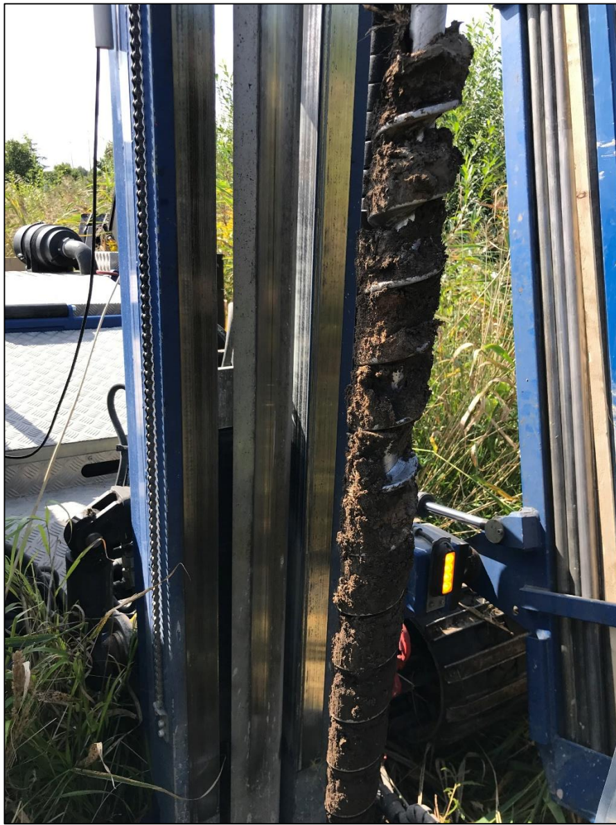
Bild 17: Pp 109, 0-1 m. Provresultat från 0-0,5 m innehåller halter av bly, kadmium och PAH-M över nivåer för mindre än ringa risk samt halter av PAH-H över KM. Provresultat från 0,5-1 m innehåller halter av bly, kadmium och zink över nivåer för mindre än ringa risk.
