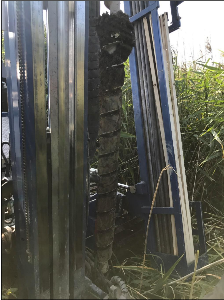
Bild 13: Pp 106, 0-1 m. Provresultat från 0-0,5 m innehåller halter av kadmium över nivåer för mindre än ringa risk.
