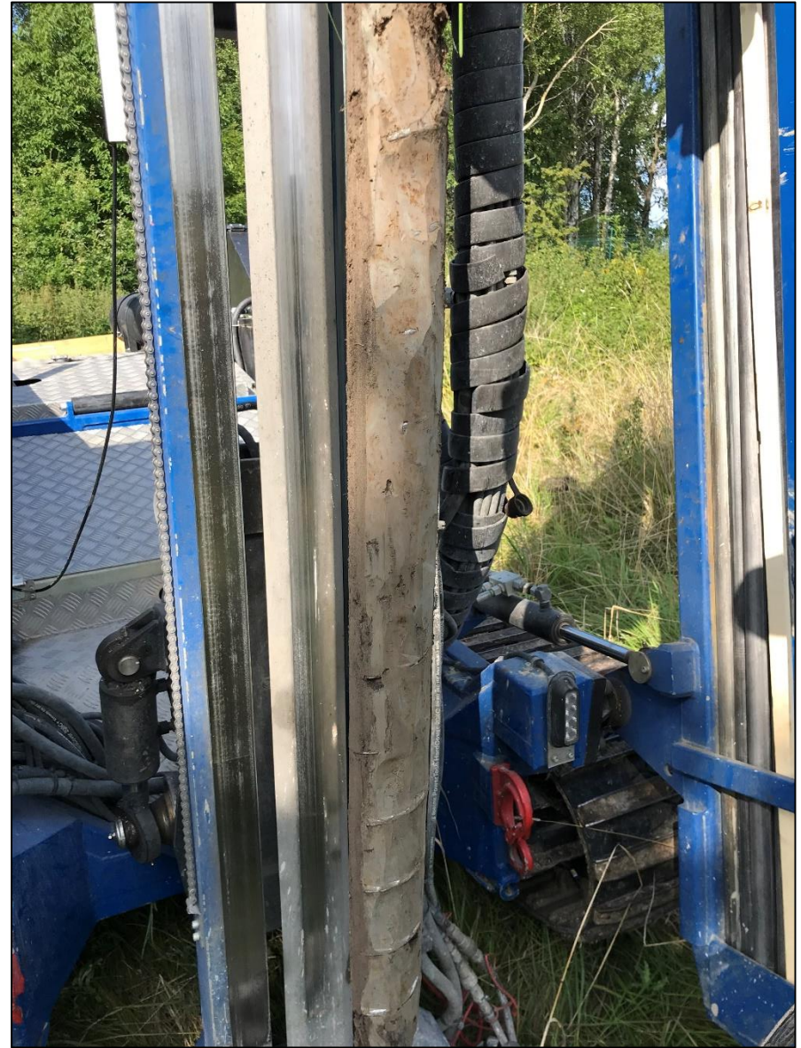
Bild 8: Pp 101, 1-2 m. Provresultat visar inga förhöjda halter av tungmetaller.
