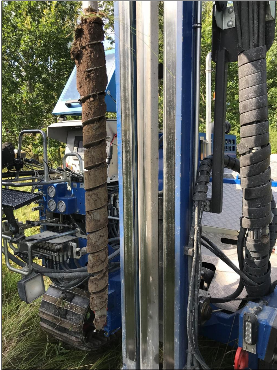
Bild 5: Pp 100, 0-1 m. Provresultat från 0-0,5 m visar inga förhöjda halter av tungmetaller.
