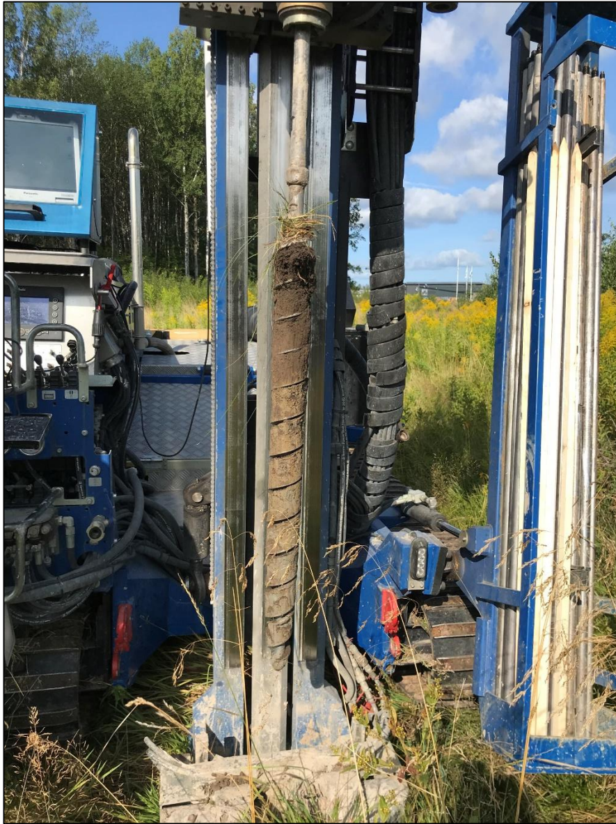
Bild 9: Pp 102, 0-1 m. Provresultat från 0,5-1 m visar inga förhöjda halter av tungmetaller.
