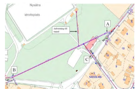
Befintlig underjordisk ledningstunnel
