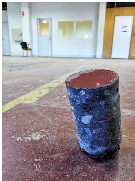
Figur 5. Betongkärna från provtagning på plan 1 i nuvarande byggnad på Rödjan 8.
