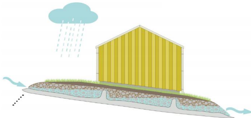
Figur 15: Profilskiss av sektionerat makadamdike för fördröjning. Källa: Ramboll
