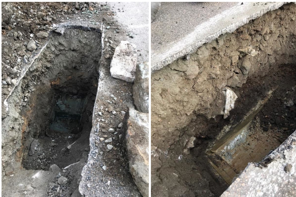
Figur 5: Bild på provgropar CWM01 (till vänster) respektive CWM05 (till höger) där fyllnadslager med stenig, grusig sand kan ses. I CWM01 syns i botten den leriga naturliga jorden. I CWM05 syns rest av markduk i schaktväggen samt bergsyta på botten av gropen 1,4 m under markyta.
