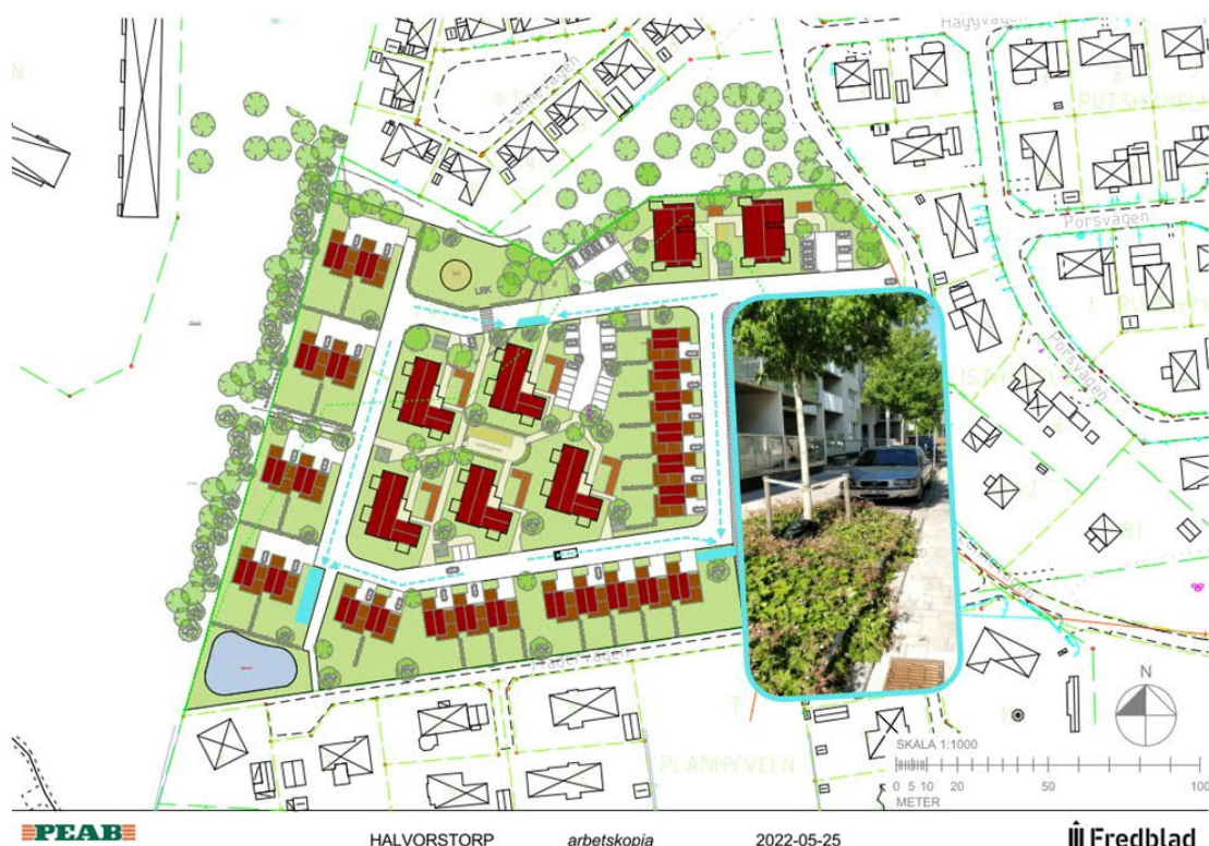
Figur 10 Förslag på placering av nedsänkta växtbäddar (turkos markering) för hantering av vägdagvattnet utifrån utformning av planområdet (situationsplan 220525, Fredblad)
