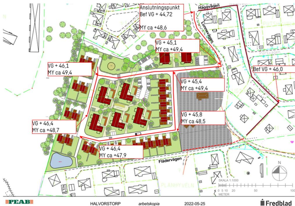
Figur 16 Schematisk illustration över föreslagen spillvattenavledning. Mörk rött streck visar schematisk streckning av befintligt kommunalt spillvattennät.
