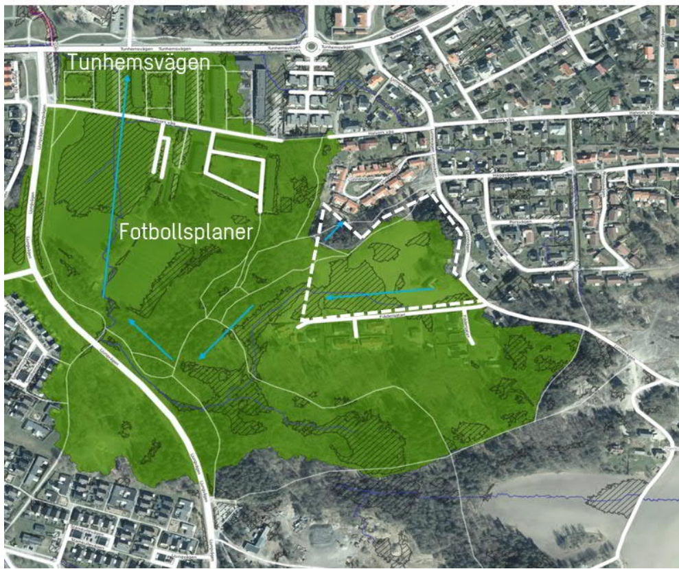
Figur 3 Befintligt avrinningsområde (grönt område) där planområdet ingår (hämtad från Scalgo Live februari 2022). Planområdet är markerad med vitstreckad linje. Svartstreckat raster redovisar potentiella instängda områden. Blåa pilar redovisar ytlig flödesriktning.
