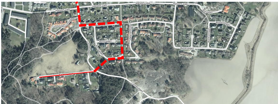
Figur 4 Kommunalt spillvattennät har ett huvudstråk enligt röd streckad linje. Röd heldragen linje visar enskilt nät som är anslutet till kommunalt nät.
