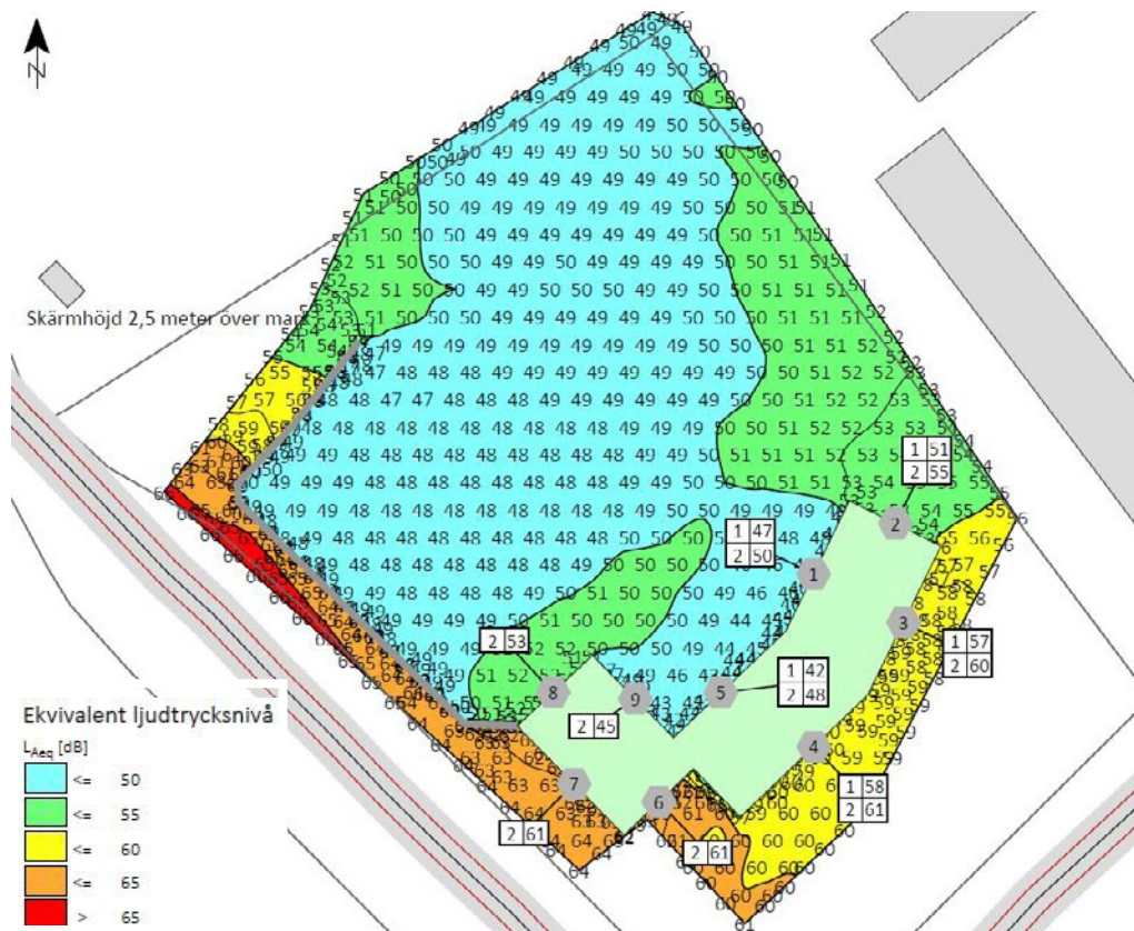
Bild 16. Ekvivalenta bullernivåer med en bullerskärm om 2,5 meters höjd. Akustikforum 2021-04-09
